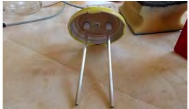
Tapa con electrodos montados (aislados arriba)
