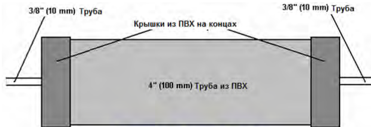
РЕЗЕРВУАР НАПОРА ГАЗА
