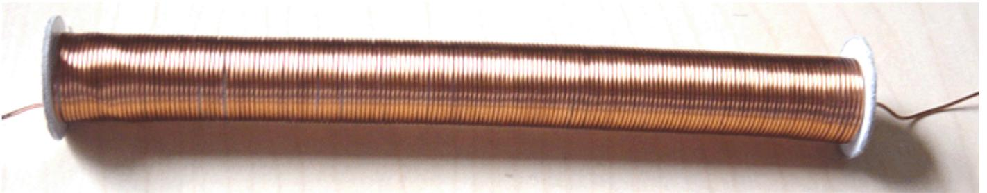
Этот генератор может быть построен в тысячах вариаций, главное отличие заключается в используемых катушках, материале сердечника, длине сердечника, диаметре проволоки и количестве намотанных слоев. Конечно, вы можете начать с одной катушки и посмотреть, как работает ваша схема, а затем добавить одну или несколько катушек для повышения производительности.
