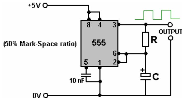
Используемый конденсатор должен быть высокого качества с очень малой утечкой, чтобы получить этот сигнал, который включен ровно столько же времени, сколько и выключен. Это важно, если мы хотим, чтобы две батареи получали одинаковое время для питания нагрузки, как и время их зарядки.
