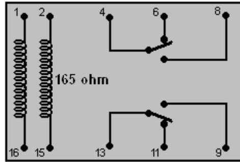
Это электронная версия механического двухполюсного переключателя. Короткий импульс тока между контактами 1 и 16 блокирует переключатель в одном положении, а затем импульс тока между контактами 2 и 15 блокирует его в другом положении. Поток тока в цепи не будет почти нулевым.
