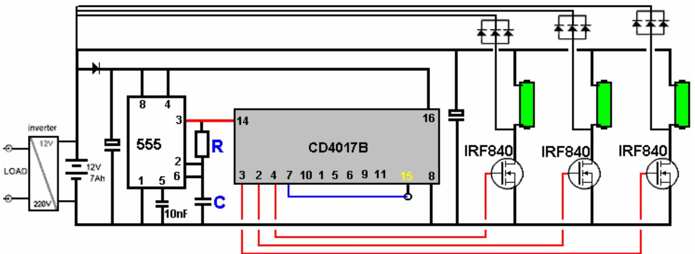
Для выхода деления на 4 контакт 10 будет подключен к контакту 15 сброса, а четвертый выход будет подключен к контакту 7, а частота тактовых импульсов 555 увеличится в четыре раза по сравнению с исходной частотой за счет уменьшения значения «С» или уменьшения значение «R».
