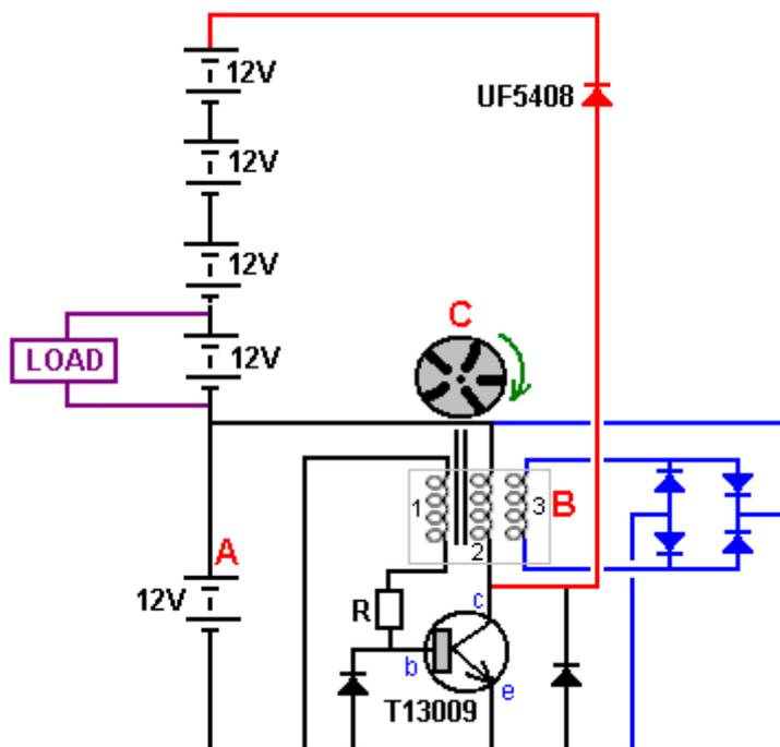
«Нагрузка» - это 150-ваттный инвертор, который преобразует 12 В постоянного тока в сетевое напряжение с частотой переменного тока, который в Южной Африке составляет 230 В при частоте 50 циклов в секунду.
