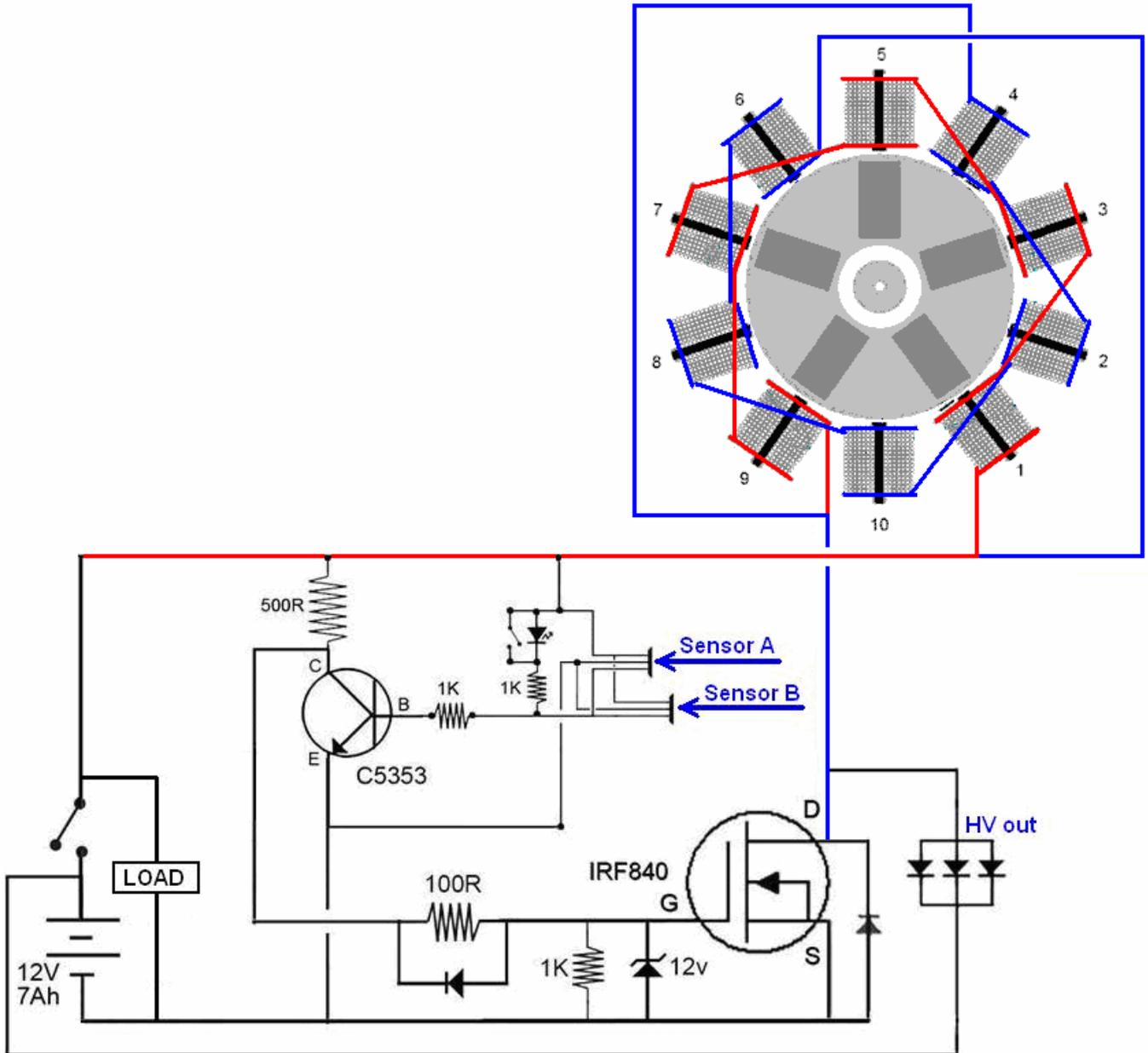
Транзистор C5353 используется для создания сильного импульса, когда один из двух датчиков Холла A3144E запускается магнитом с проходящим ротором, и это включает IRF840 FET.
