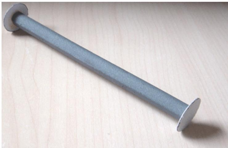
Отрежьте лист бумаги шириной 140 мм длиной 32 мм. Эта ширина соответствует зазору между фланцами катушки. Прикрепите полоску изоленты или липкой лентой к бумаге так, чтобы она перекрывалась на половину своей ширины по всей полосе бумаги и отложите её до тех пор, пока не будет намотан первый слой проволоки.
