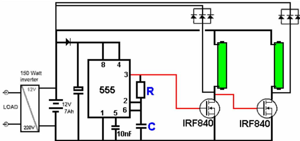
Тогда, когда первый транзистор включается, второй транзистор выключается, и наоборот. Это возвращает вдвое больше импульсов в секунду к батарее привода, не увеличивая частоту импульсов одной из цепей катушки. Помните также, что транзисторы достаточно мощны, чтобы управлять несколькими цепями катушек одновременно, и каждая дополнительная катушка может увеличить доступную выходную мощность.
