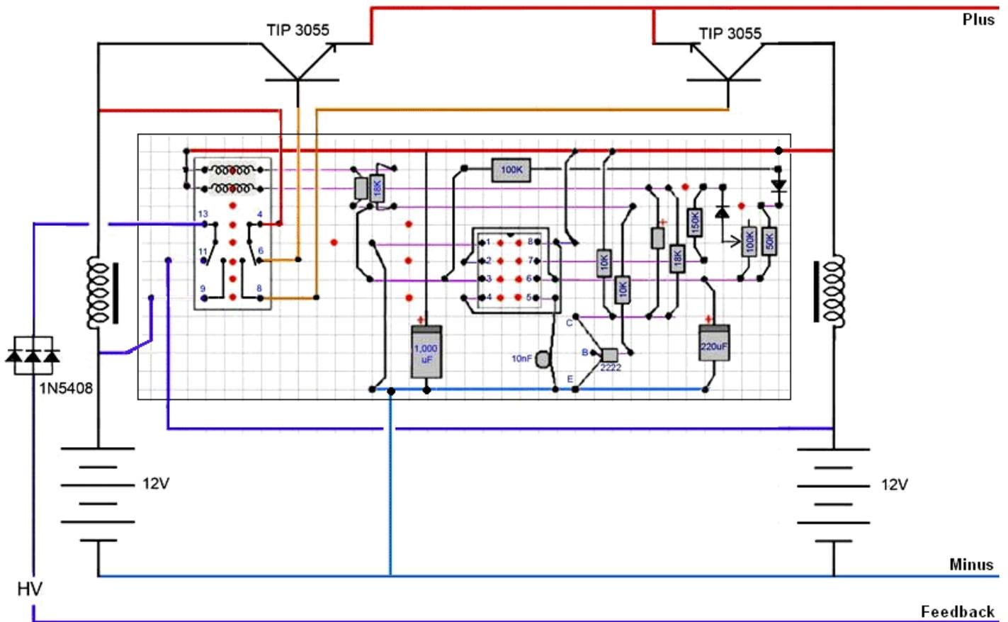
Транзисторы TIP3055 предназначены только для увеличения пропускной способности крошечного реле блокировки.
