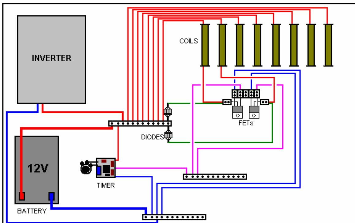
Такое расположение сводит пайку к минимуму и позволяет легко вносить изменения, поскольку цепь расширяется для более высокой выходной мощности. Плата таймера может быть заменена позже, если вы решите использовать стиль деления на N. Предполагается, что единственная длинная тонкая форма катушки является наиболее эффективной для этого применения, но это еще не доказано.
