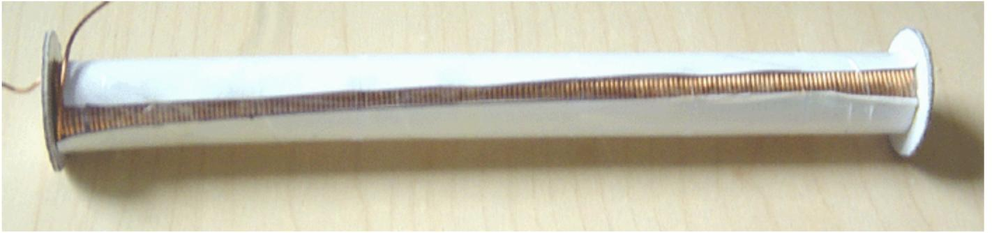
Этот процесс повторяется до тех пор, пока все желаемые слои не будут намотаны. Наконец, провод обрезается с несколькими дюймами запаса, оставленных для подключения катушки в цепь и провод проходит через второе отверстие в одном из фланцев:
