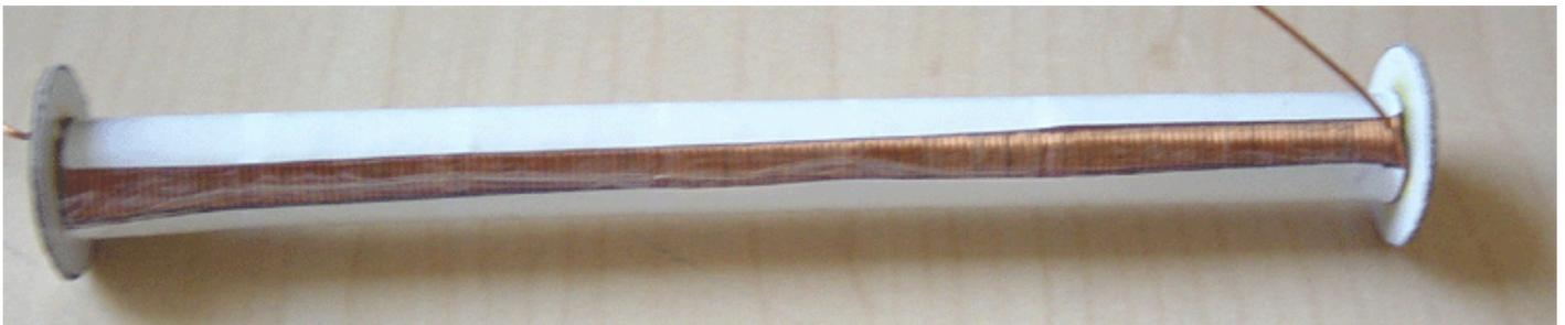
Теперь у вас есть отлично намотанный первый слой. Перед началом второго слоя разрежьте следующую полосу бумаги шириной 40 мм. Приклейте полосу изолянт по длине бумаги, опять же, половина ширины изолянт перекрывает бумагу и отложите ее в сторону. Обмотайте следующий слой точно таким же образом, закончив, приклеив и закрепив бумагу вокруг сердечника двумя слоями проволоки.
