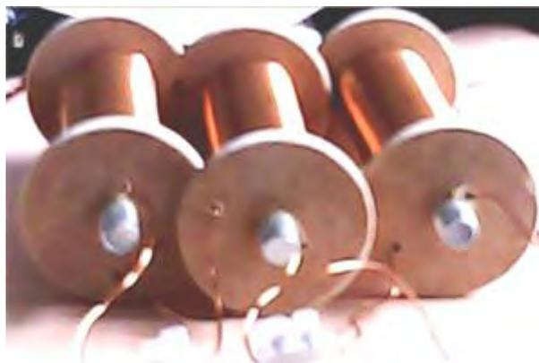
Три таких катушки могут быть намотаны с одного 500-граммового барабана из провода 0,71 мм, и железных сердечников и они безусловно смогут работать с частотой более 6000 Гц. Каждая из этих катушек имеет около 315 витков и сопротивление постоянному току 1,6 Ом. Однако феррит обычно считается лучшим сердечником для работы на высоких частотах и его можно довольно
