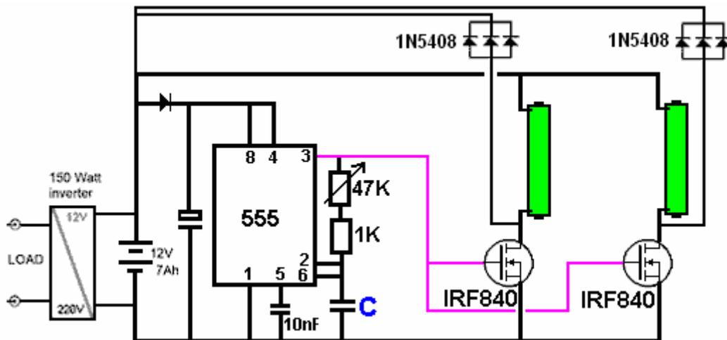
Такое расположение позволяет значительно изменить рабочую частоту, просто повернув ручку. Опытные конструкторы будут иметь свои собственные предпочтительные методы построения, но мы могли бы выбрать использование макета на открытой доске, чтобы упростить просмотр происходящего и обеспечить хорошее охлаждение на этапе разработки, возможно что-то вроде этого:
