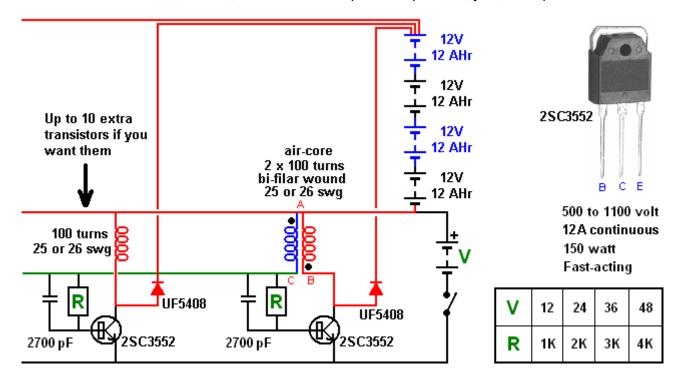
Конденсатор 2700 пФ рекомендуется для каждого дополнительного транзистора, но он не является обязательным элементом и схема будет работать нормально только с конденсатором в секции привода двухпроводной катушки.
