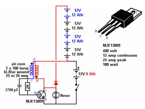
Катушка наматывается на полую форму с использованием двух отдельных жил проволоки диаметром 0,5 мм, что дает сопротивление всего в 2 Ома. Жилы проволоки располагаются рядом в один слой, например:
