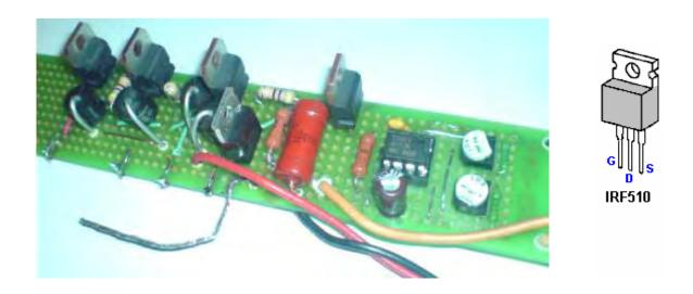
С этими схемами можно использовать различные различные высоковольтные транзисторы. Поскольку некоторые люди испытывают затруднения при разработке подходящей физической конструкции для схемы, вот предложение о возможной компоновке с использованием мощного транзистора с высоким коэффициентом усиления МJ11016 на плате.
