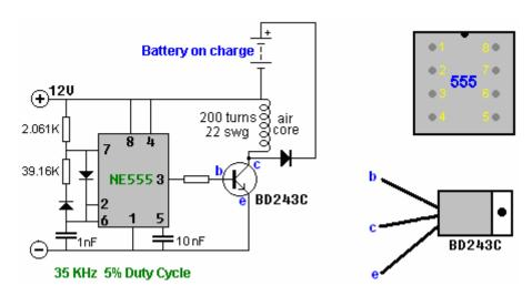
Эта простая схема колеблется 35 000 раз в секунду, и она отключается в 95% случаев. Катушка очень проста и составляет всего 200 витков эмалированного одножильного медного провода диаметром 0,71 мм.
