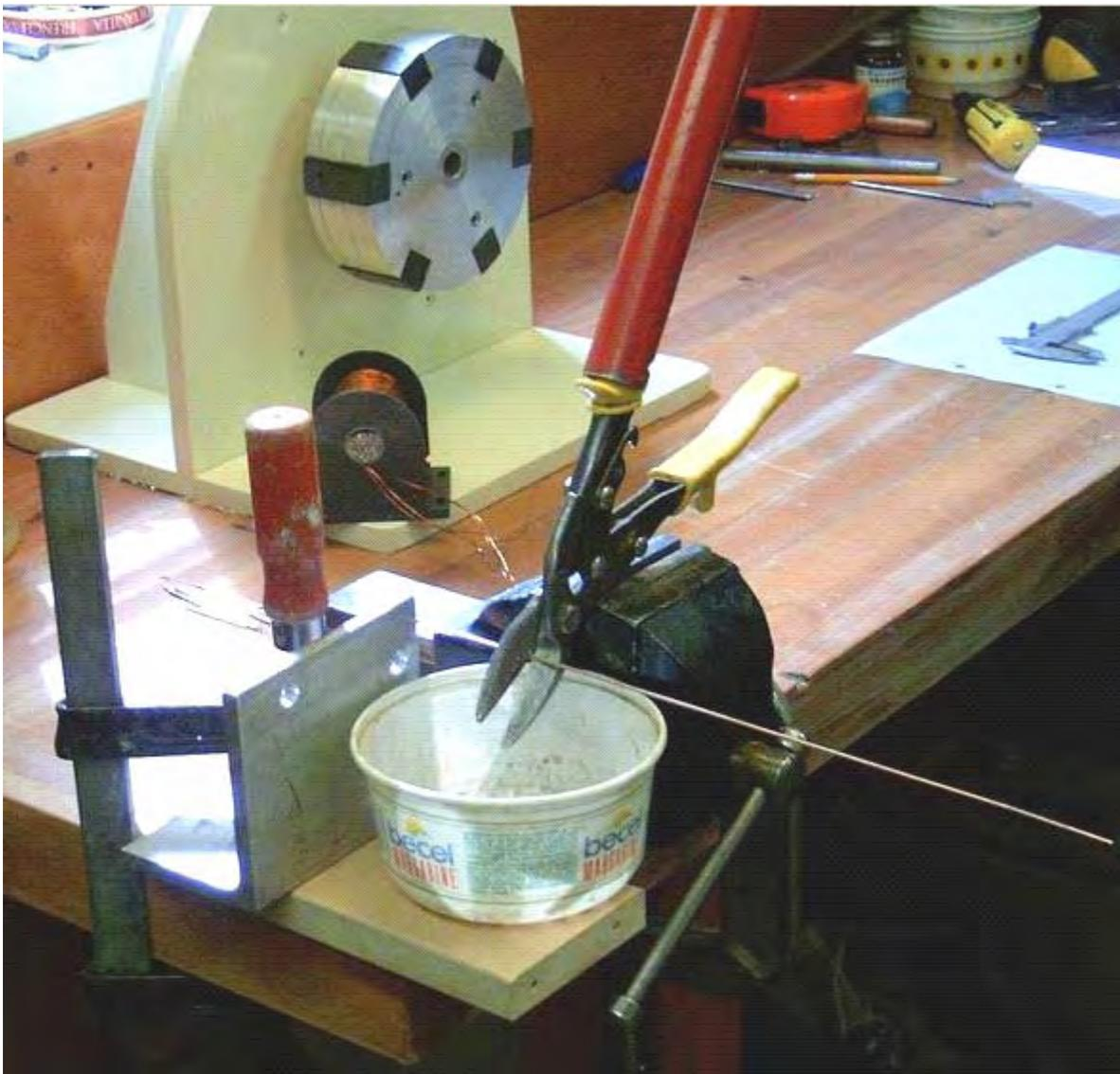
Расстояние между ножницами и металлическим углом, закрепленным на верстаке, делает каждую отрезанную длину проволоки точно нужного размера, в то время как пластиковый контейнер собирает отрезанные куски, готовые для нанесения покрытия с прозрачным шеллаком или прозрачным полиуретановым лаком, перед использованием в сердечниках катушки.
