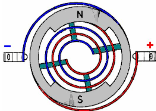
Магниты расположены так, чтобы создавать магнитное поле, которое проходит через ось электролизера. Прокладки (показаны зеленым цветом) не являются непрерывными, но являются совершенно отдельными и они существуют для того, чтобы вызывать турбулентность, а также вызывать желаемое расстояние между электродами:
