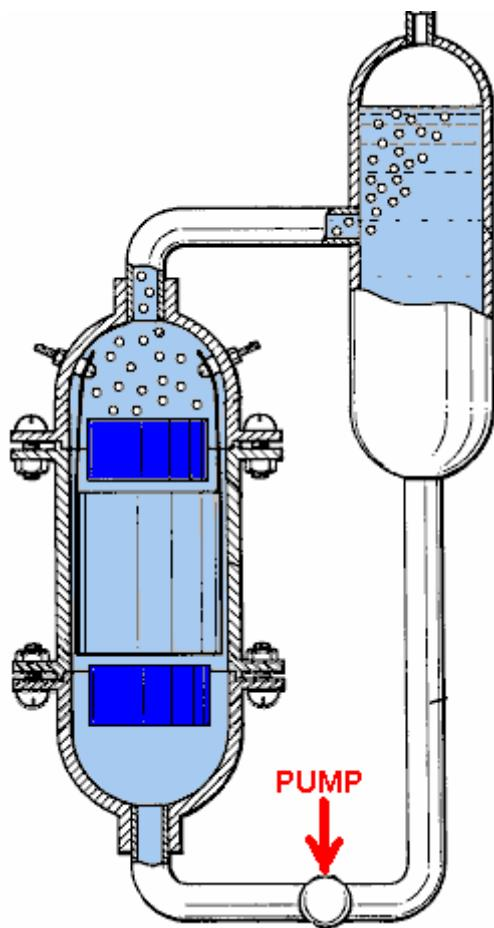
Выходная труба электролизера соединена со стороной резервуара с электролитом и там пузырьки всплывают вверх и выходят через барботер, в то время как оставшийся электролит насос снова циркулирует.
