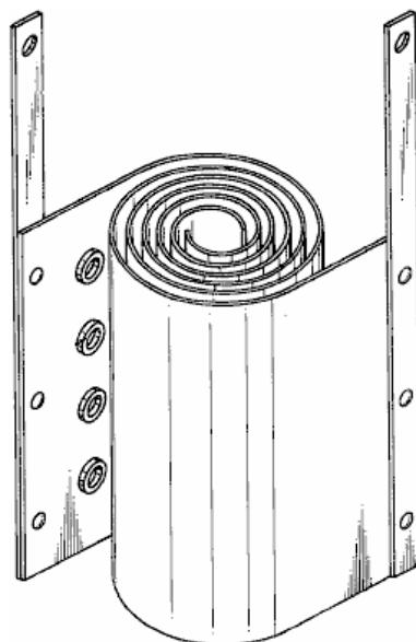
Эти электроды удивительно трудно изготовить вручную, но их должно быть очень просто построить с использованием 3D-принтера. Эти электроды затем крепятся болтами к непроводящему корпусу:
