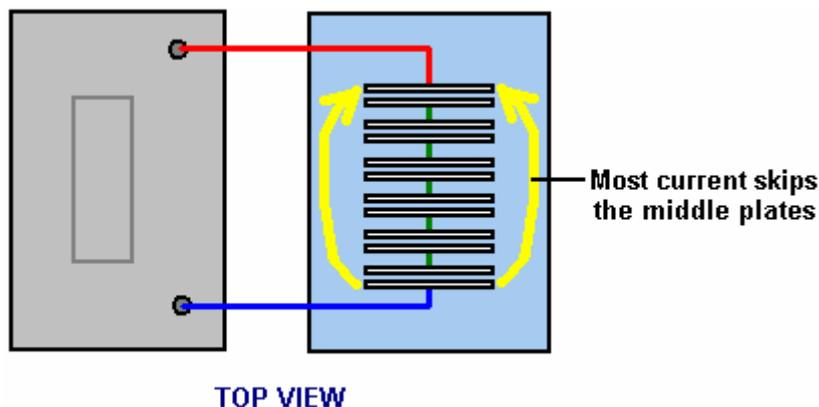
Для нас это катастрофа, так как теперь мы не сможем получить в шесть раз больше добычи газа или значительного сниженного тепловыделения. К счастью, есть очень простое решение этой проблемы, которое состоит в том, чтобы разделить коробку на шесть водонепроницаемых отсеков, используя тонкие перегородки, подобные этой:
