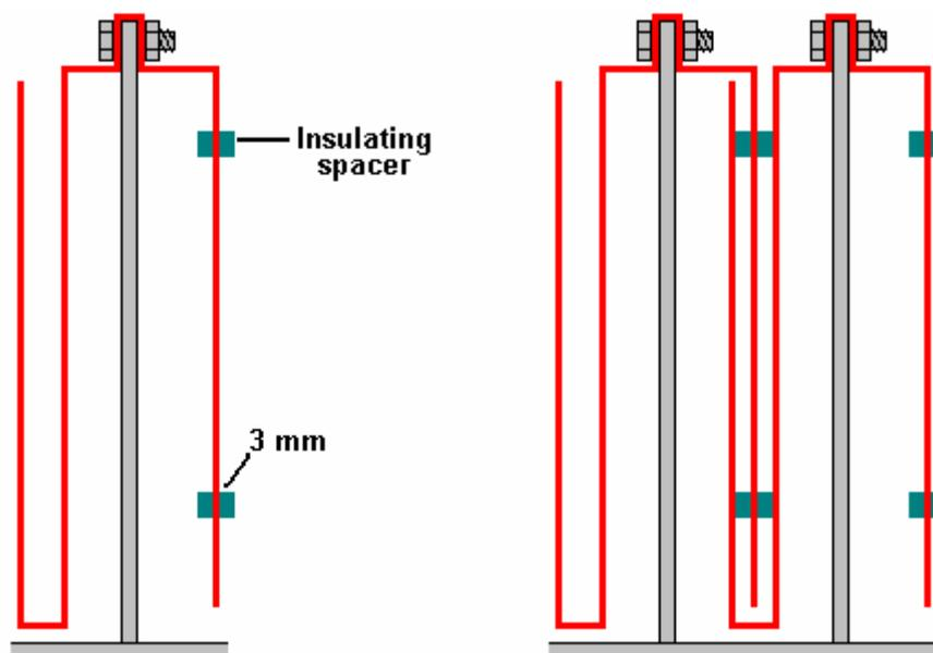
Если ток достаточно низкий, можно использовать ещё более простую форму, которая имеет только одну пару активных поверхностей пластины на ячейку, как показано здесь:
