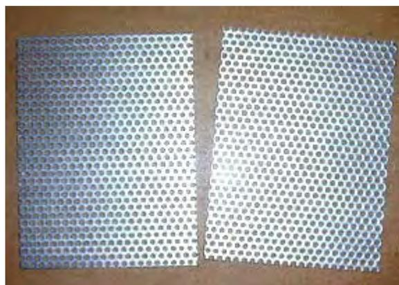
Ваш местный поставщик стали, вероятно, имеет несколько типов под рукой и может показать вам, насколько гибок тот или иной сорт. Форма, показанная выше, предназначена для конструкции «три пластины на ячейку», где есть две активные поверхности пластины. В идеале вам нужно от двух до четырех квадратных дюймов площади пластины на ампер тока, протекающего через элемент, потому что это обеспечивает очень длительный срок службы электрода и минимальный нагрев благодаря пластинам.
