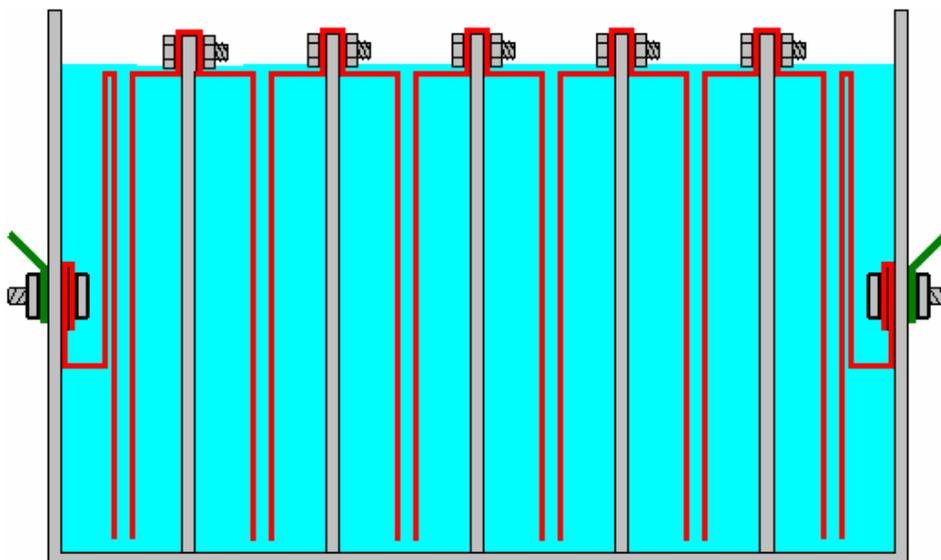
Любая из этих конструкций может быть 6-элементной или 7-элементной и пластины могут быть изготовлены без посторонней помощи. Вы заметите, что электрические соединения на каждом конце усилителя погружены, чтобы убедиться, что слабое соединение не может вызвать искру и воспламенить газ  $\text{H}_2\text{O}$  в верхней части корпуса. Внутри должна быть прокладочная шайба, чтобы предотвратить утечку электролита через зажимной болт.
