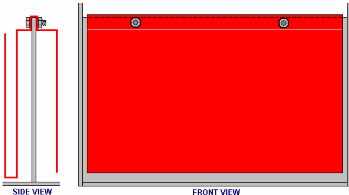
Приведенные выше формы пластин расположены таким образом, чтобы к болтам был доступ сверху, и их можно было достать гаечным ключом и удерживать их неподвижно, пока другая гайка затягивается.
