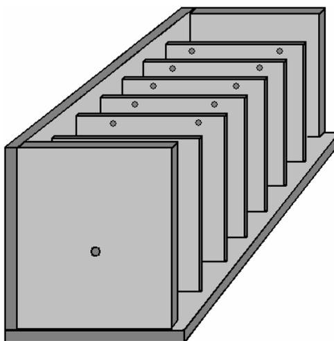
Здесь перегородки фиксируются на месте по одной и наконец, вторая сторона прикрепляется и соединяется точно, так как перегородки и концы имеют одинаковую ширину. Простая конструкция крышки состоит в том, чтобы приклеить и прикрутить полосу вокруг верхней части устройства, и крышка должна перекрывать стороны, как показано здесь:
