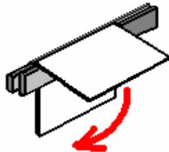
Толщина стального стержня на внутренней стороне изгиба должна быть точной шириной необходимого зазора между готовыми поверхностями пластины. Это не особенно сложно организовать, так как 3 мм, 3,5 мм, 4 мм, 5 мм и 6 мм - обычные толщины, используемые при изготовлении стали, и их можно комбинировать, чтобы получить практически любой требуемый зазор.
