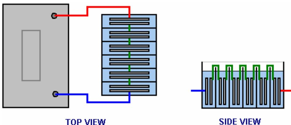
Это возвращает нам нашу высокую эффективность, блокируя ток протекающий через пластины, и заставляя ток течь через пластины, производя газ между каждой парой пластин.
