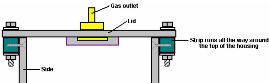
Прокладка, возможно, из гибкого ПВХ, помещенная между сторонами и крышкой, поможет создать хорошее уплотнение, когда крышка закреплена болтами вниз. Выпускная труба для газа расположена в центре крышки, и это положение не изменяется, если устройство наклоняется, когда автомобиль находится на крутом склоне.
