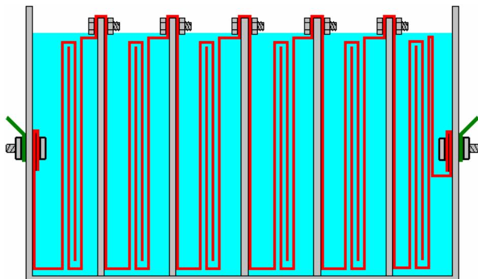
**Электролит** представляет собой смесь воды и добавки, которая позволяет большему току течь через жидкость. Большинство веществ, которые люди думают использовать для получения электролита, являются наиболее неподходящими: они образуют опасные газы, повреждают поверхности пластин и дают неравномерный электролиз и токи, которые трудно контролировать. К ним относятся соль, аккумуляторная кислота и пищевая сода и я настоятельно вам не рекомендую использовать ничего из этого.
