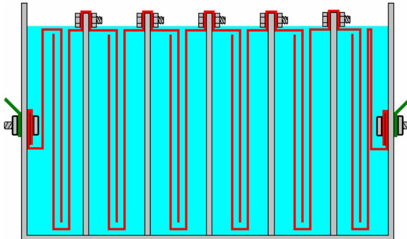
Хотя этот дизайн с шестью ячейками на первый взгляд может показаться немного сложным, на самом деле это очень простая конструкция. Каждая из пластин, используемых в центральных ячейках, имеет такую форму:
