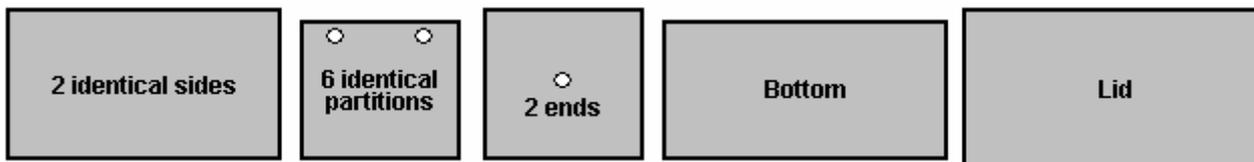
Длина нижней части равна длине сторон, а ширина перегородок плюс удвоенная толщина материала, используемого для сборки корпуса. Если для строительства используется акриловый пластик, то поставщик может также предоставить «клей», который эффективно «сваривает» куски вместе, создавая видимость того, что разные кусочки изготовлены из одного куска. Корпус будет собран так:
