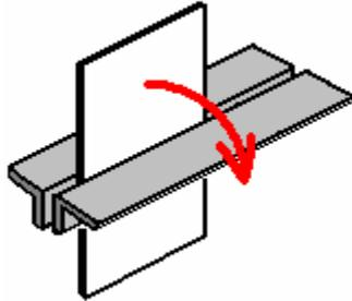
Изогнутый лист можно затем зажать между двумя стальными полосами и острым U-образным изгибом, полученным повторным постукиванием молотком по линии требуемого изгиба:
