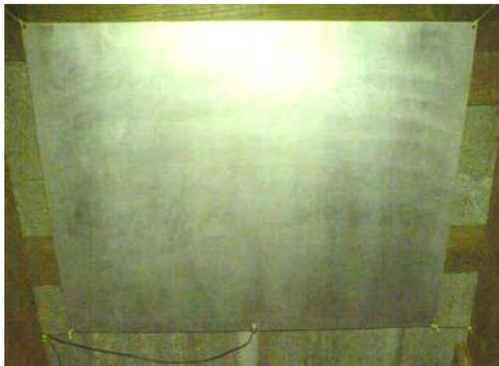
Пластина подвешивается с помощью нейлонового шнура, чтобы она не касалась крыши или чего-либо еще:
