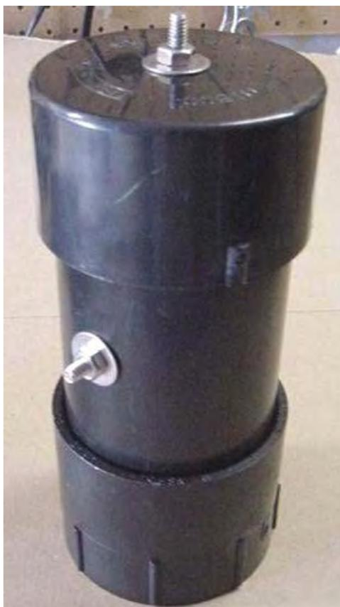
Это готовая ячейка, показанная здесь с ног на голову. Соберите устройство с помощью клея ABS.
