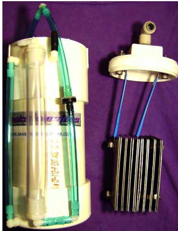
На рисунке выше четко показаны используемые настенные пластины и то, как барботер крепится к корпусу усилителя с помощью супер-клея. Также показаны различные соединения труб. Пластины крышки выключателя из нержавеющей стали имеют размер 2,75 x 4,5 дюйма (70 x 115 мм), и их существующие монтажные отверстия высверлены до диаметра 5/16 дюйма (8 мм), чтобы взять пластиковые болты, используемые для удержания пластины вместе, чтобы сделать
