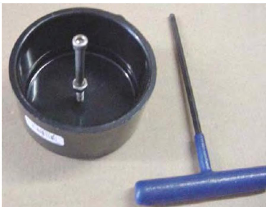
Подготовьте нижнюю крышку: просверлите и коснитесь отверстия 1/4 дюйма х 20 в центре. Установите болт с гайкой из нержавеющей стали. Затяните и установите шайбу и гайку из нержавеющей стали снаружи.
