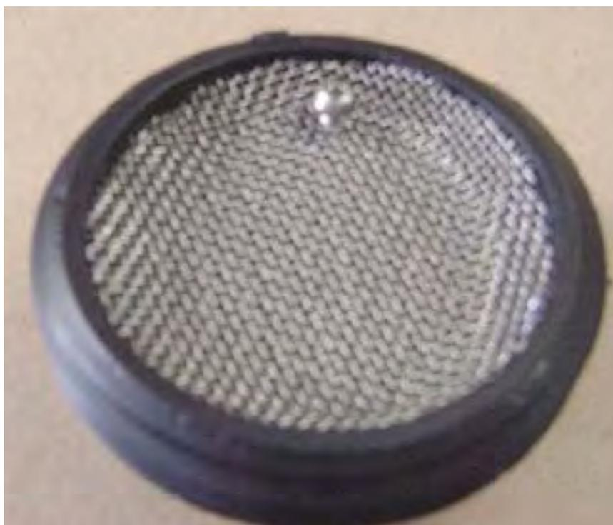
Плотно вставив сетку в крышку, установите ее с помощью винта из нержавеющей стали 10/32 дюйма на противоположной стороне с резьбовым отверстием 1/4 дюйма для зазубренного фитинга. Это пламегаситель, поэтому убедитесь, что все внутри плотно закрыто. Обратите внимание, что стороны завернуты. Поверните каждый слой, чтобы пересечь зерно сетки в последовательных слоях.
