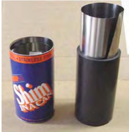
Отрежьте и вставьте шимсток в трубку АБС, хорошо работает 11 дюймов, это дает 1-дюймовое перекрытие.
