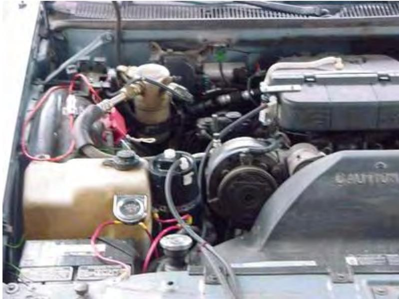
Все 3/8-дюймовые пластиковые фитинги, включая односторонние клапаны, поставляются Ryanherco и изготовлены из Kynar для противостояния высокой температуре. Водоотделитель от воздушного компрессора. Трубка или шланг 3/16 дюйма также имеют высокую температуру нагрева от охлаждающей жидкости автоматической коробки передач. Я использую постоянный ток и ограничен терморегулятором и регулировкой смеси LYE.
