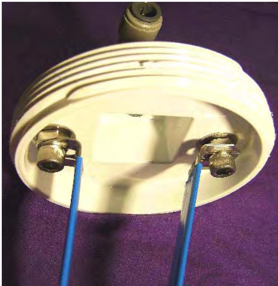
Чтобы обеспечить надежное соединение ремешков из нержавеющей стали с электропроводкой, болты крышки расположены на прочной горизонтальной поверхности крышки и надежно закреплены как внутри, так и снаружи. Резиновая шайба или резиновая прокладка используются для усиления уплотнения снаружи крышки. Если возможно, можно использовать стальную шайбу со встроенной резиновой облицовкой.
