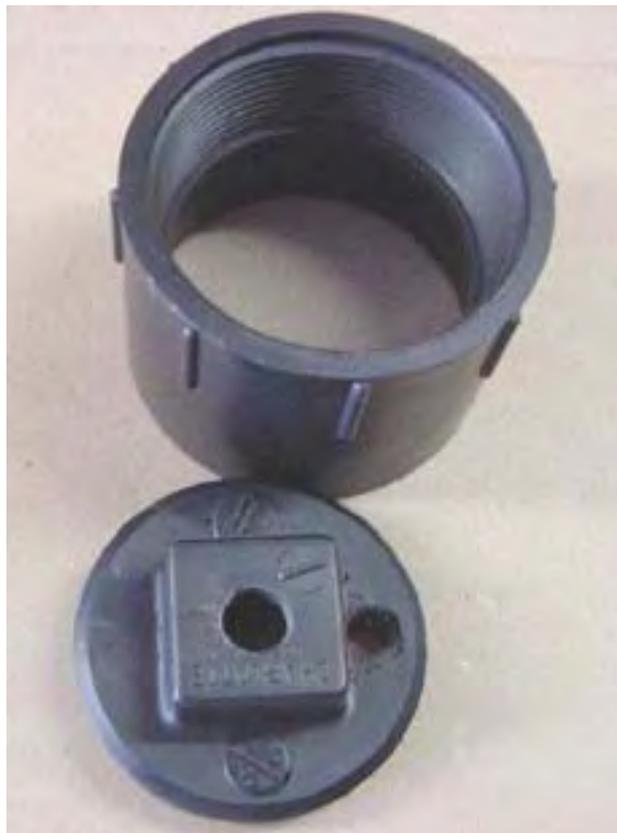
Верхним компонентом является резьбовой адаптер DWV 3 дюйма NXFPT. Нижний элемент представляет собой 3-дюймовую вилку ABS, очистите резьбовую крышку. Подготовьте верхнюю крышку и пробку: просверлите и постучите по NPT диаметром 3/8 дюйма в центре резьбовой пробки (это основная пробка для заливки). Просверлите и постучите по 1/4 дюйма NPT сбоку (чтобы взять зазубренный фитинг).
