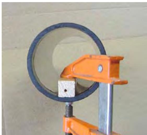
Надежно закрепите и просверлите два отверстия диаметром 0,165 дюйма, по одному с каждой стороны, перпендикулярно друг другу, насколько это возможно. Эти отверстия будут пробиты 1/4 дюйма x 20.
