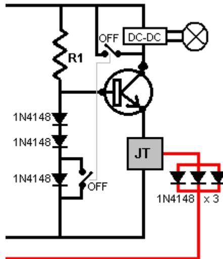
El circuito como se muestra hasta ahora tiene dos juegos de cuatro baterías. Sería bueno cambiar entre ellos cada pocos minutos. Las baterías que proporcionan energía a una carga no se cargan tan bien como las baterías descargadas que se están cargando. Sin embargo, el mecanismo que alterna entre los dos juegos de baterías necesita tener un consumo de corriente extremadamente bajo para no desperdiciar corriente. Una posibilidad para eso sería usar un relé de enclavamiento como este:
