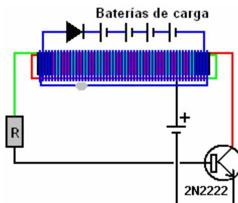
Con esta disposición, el segundo devanado también se realiza con dos cables uno al lado del otro y luego el extremo del primer cable se conecta permanentemente al inicio del segundo cable, dejando solo un cable que sale de cada extremo del nuevo devanado. La corriente extraída de este nuevo bobinado no afecta el consumo de corriente de la batería de accionamiento que está ejecutando el circuito Joule Thief.
