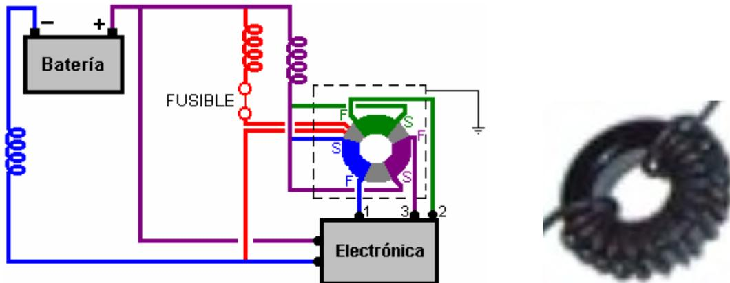
El estrangulador se muestra en rojo en el diagrama es de alrededor de 18 vueltas en un pequeño toroide que parece bien, pero los otros dos bobinas parece ser tan sólo seis o siete bucles en los cables de conexión, no terminó al lado del otro en una antigua magnético, pero sólo izquierda como si el acortamiento de la longitud del cable.
