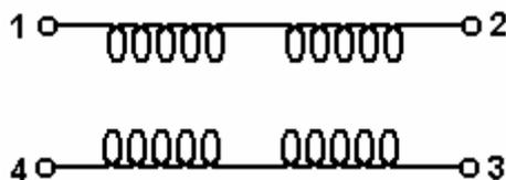
Esto produce dos cadenas de bobinas separadas: 1 a 2 y 4 a 3. Uno se puede usar como bobina emisora y otro como bobina receptora que pasa los cortísimos impulsos de voltaje hacia la batería que está siendo cargada.
