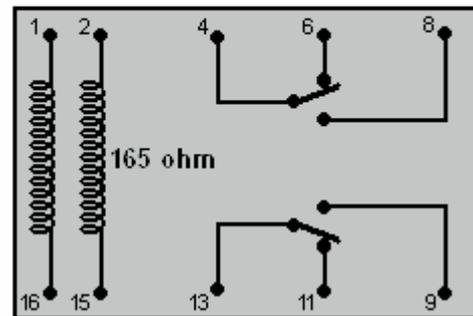
Esta es la versión electrónica de un interruptor mecánico de dos polos. Un breve impulso de corriente entre dos pines bloquea el interruptor en una posición y más tarde, un pulso de corriente entre otros dos pines lo bloquea en la otra posición. La fuga de corriente en el circuito sería casi cero.
