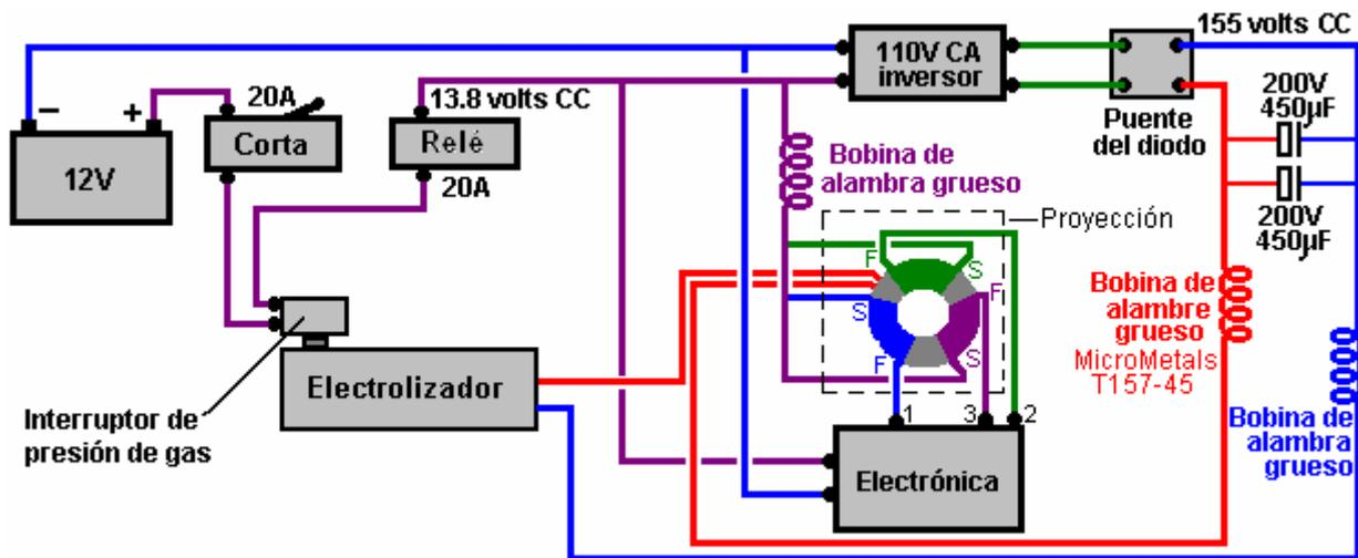
Lo que para un sistema de baja tensión (no necesitar de alta tensión para 100 células electrolizador en serie) presumiblemente sería:
