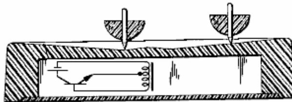
Cuando las cumbres giran rápido, ellos se elevan la base inclinada del plato y vuelta cerca del borde externo. Cuando ellos reducen la velocidad ellos mueven hacia atrás hacia el centro del plato y esto provoca la batería/transistor/electroimán incorporada en la base del plato. El pulso del electroimán incrementa la vuelta de la cumbre, devolviéndolo la cuesta. Este es un arreglo muy ordenado cuando el transistor es de la mayor parte del tiempo y aún las dos cumbres siguen girando.
