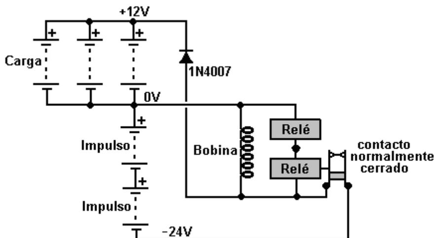
Cuando se usa este sistema de carga por relés se va a producir bastante ruido. Se puede reducir fácilmente con alguna pantalla, tiene la ventaja de que indica cuando la carga se está realizando correctamente.
