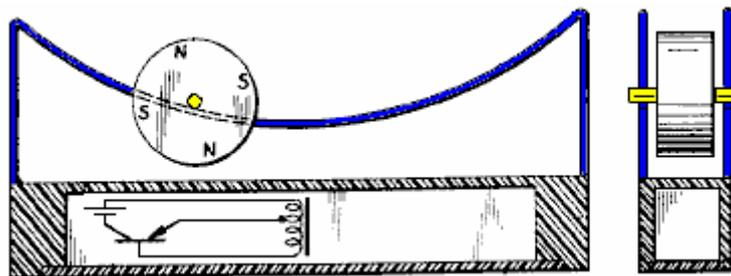
Esto funciona de casi el mismo modo, con una rueda magnética que rueda de acá para allá a lo largo de una pista curva. En el punto más bajo, el electroimán es provocado por el voltaje inducido en algunas vueltas del bobina, impulsando el transistor e incrementando el rodillo magnético en esto es el camino.
