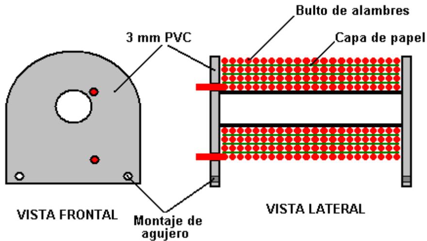
Los bobinas se enrollan con los platos del extremo atados y taladraron listo para atornillar a su 1/4 pulgada (6 mm) PVC basa que es los echamos el cerrojo a a la 3/4 pulgada (18 mm) MDF la estructura de apoyo. Para ayudar el bobinado para permanecer completamente incluso, un pedazo de papel se pone encima de cada capa del bobinado:
