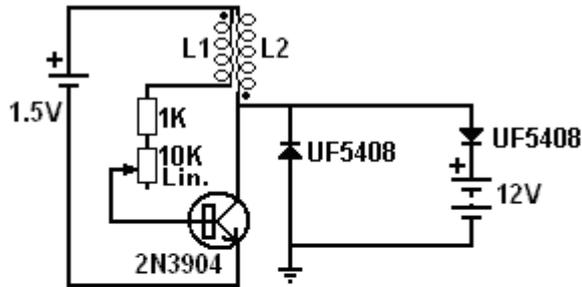
**Bobinas: alambre de cobre sólido de diámetro 0.5 a 1.0 mm**
