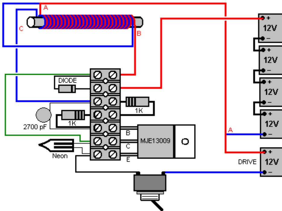
Un recorrido hasta más avanzado de Alex tiene la interpretación aún más alta usando un transistor rápido y un muy diodo de acción rápida, y un neón no es necesario para proteger el transistor:
