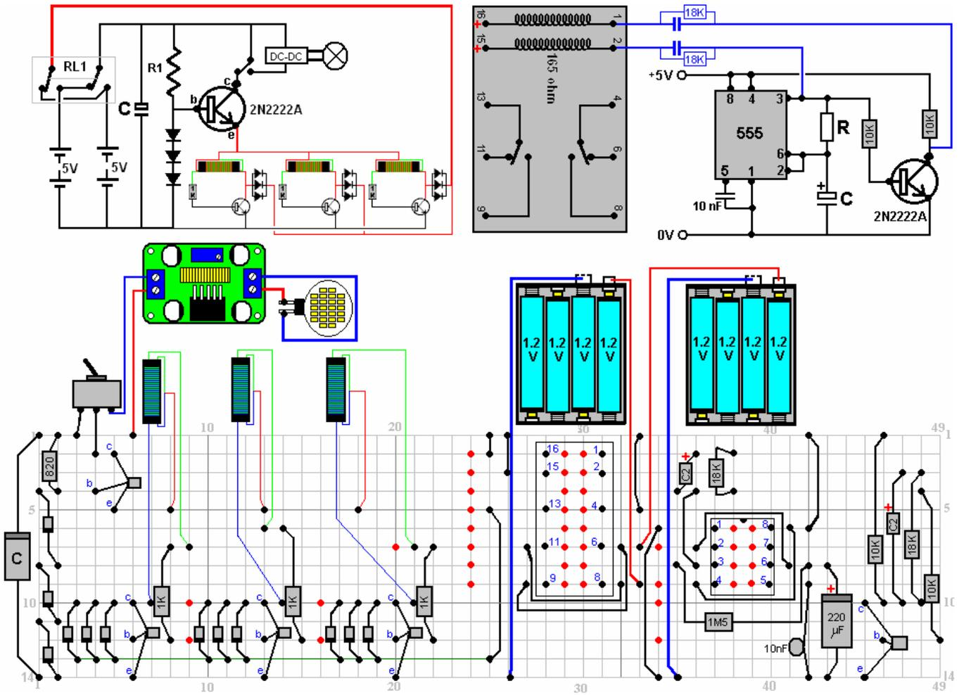
Los puntos rojos en el diseño físico sugerido indican lugares donde la tira de cobre en la parte inferior del tablero está rota.
