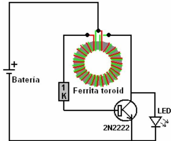
La bobina original estaba hecha de dos hilos de alambre enrollados uno al lado del otro alrededor de un pequeño anillo de ferrita o "toroide". El circuito oscila automáticamente, generando un voltaje mucho más alto en el colector del transistor, y aunque el voltaje de la batería no es suficiente para que el LED se ilumine, el circuito se enciende con bastante facilidad.
