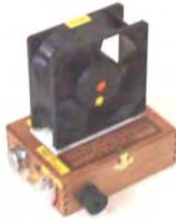
Esta unidad funciona con una batería de 9V PP3 como la batería de accionamiento y carga una batería recargable de 9V PP3 cuando se está ejecutando. Ambas baterías están encerrados en la caja en esta construcción muy cuidada.
