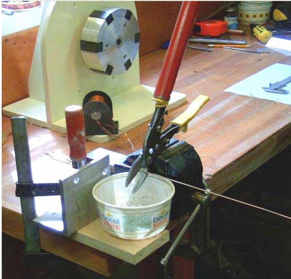
La distancia entre las tijera grandes y el ángulo de metal sujetados al banco de trabajo hace el tamaño requerido exactamente a cada longitud cortada de alambre mientras el recipiente plástico colecciona que los pedazos cortados preparan por cubrir con laca clara o el polyurethane claro barnice antes del uso en los centros del bobina.
