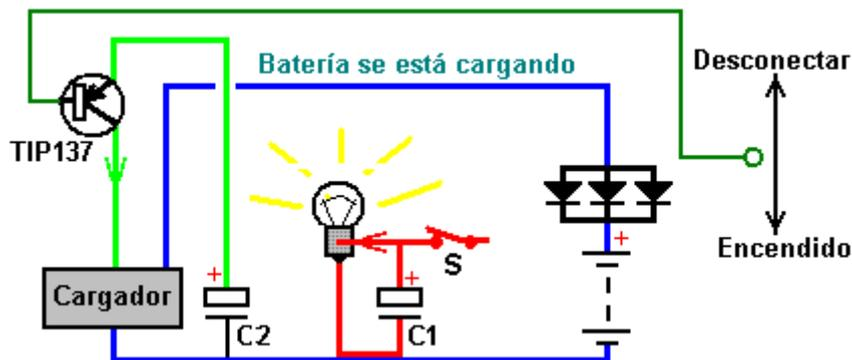
Aquí, el cargador está conectado a la batería en todo momento, a través de un diodo (o tal vez más prácticamente, a través de tres o cuatro diodos, tales como UF5408, en paralelo que alimenta corriente mejor que un diodo en su propio), lo que lleva a un circuito algo como esto:
