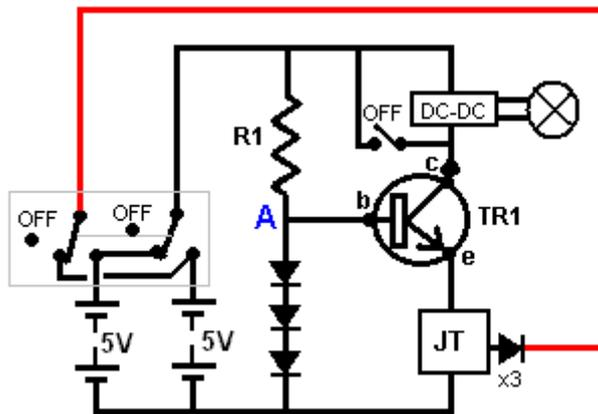
Este circuito funciona realmente bien. La corriente alimentada al convertidor elevador de CC a CC está controlada por la tensión en el punto "A" y la resistencia general del circuito Joule Thief. Como se muestra, dibuja unos 70 miliamperios y enciende una o dos de las matrices LED brillantemente durante seis horas cuando se alimenta con un juego de cuatro de las baterías Digimax 2850 mAHr de tamaño AA.
