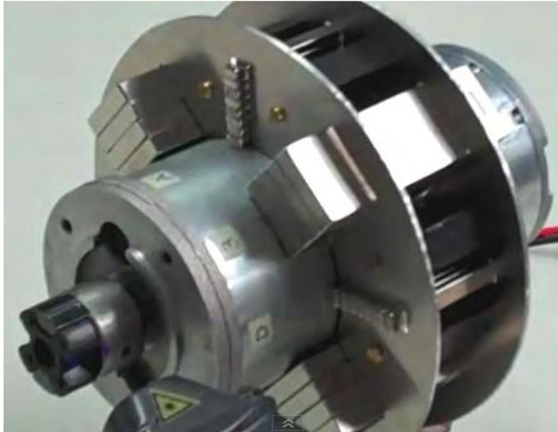
Con este arreglo, el motor corre en diez veces esto es la velocidad de diseño (que lo destruiría muy rápidamente), entonces es dirigido con sólo un sexto de esto es el voltaje de diseño. Esto es usado para conducir un generador eléctrico mostrado en dos videos en: <http://www.youtube.com/watch?v=0dkiHUasERA&feature=related> y <http://www.youtube.com/watch?v=ZTLvqCiKadI&feature=related> que explican los rasgos de diseño sofisticados de este generador que ha sido construido con el gran cuidado:
