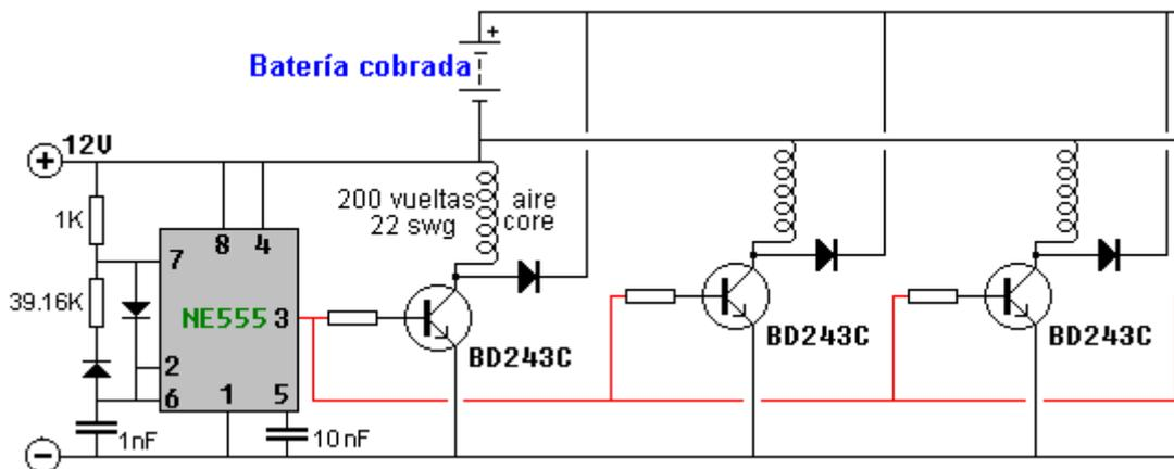
Como se puede ver en la fotografías Alex usa valores prefijados para las resistencias que dan los valores óptimos. La simplicidad de este circuito lo hace apetecible para un proyecto de construcción y usar más de una bobina puede conducir a resultados impresionantes. Alex dice que los mejores resultados se pueden conseguir con un diodo de 10 A ,1000 V y no un puente rectificador, lo pone de relieve en los comentarios educativos de la página web citada.
