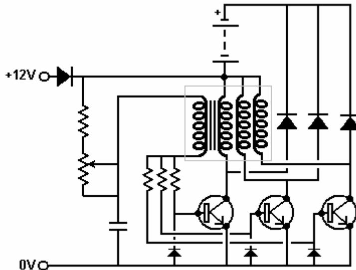
En este circuito, los cuatro (o más) bobinas se enrollan como una unidad con los cuatro cables fijados al lado del otro. Los diodos adicionales están ahí para proteger los transistores y las resistencias de base se ajustaron para dar un flujo de corriente realista en el circuito que mantiene a los transistores se enfrían cuando el circuito está en funcionamiento.
