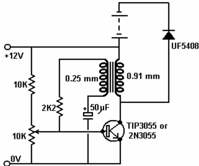
Cuando se ajusta correctamente, este circuito funciona fresco sin ninguna necesidad de un disipador de calor en el transistor. El tamaño del condensador no es crítica y se puede ajustar para el mejor rendimiento. Las bobinas se enrollan con longitudes iguales de alambre y enrollado con la cara cables al lado del otro, ya sea con núcleo de aire o con un núcleo de alambre de soldadura aislado de esta manera:
