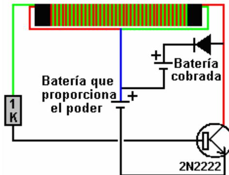
La bobina se puede enrollar con bastante facilidad. Un lápiz es una buena formadora para una bobina, por lo que debe cortar una tira de papel de 100 milímetros de ancho y enrollarla alrededor del lápiz para formar un cilindro de papel de varias capas de espesor y 100 milímetros de ancho y sellarlo con Selotape:
