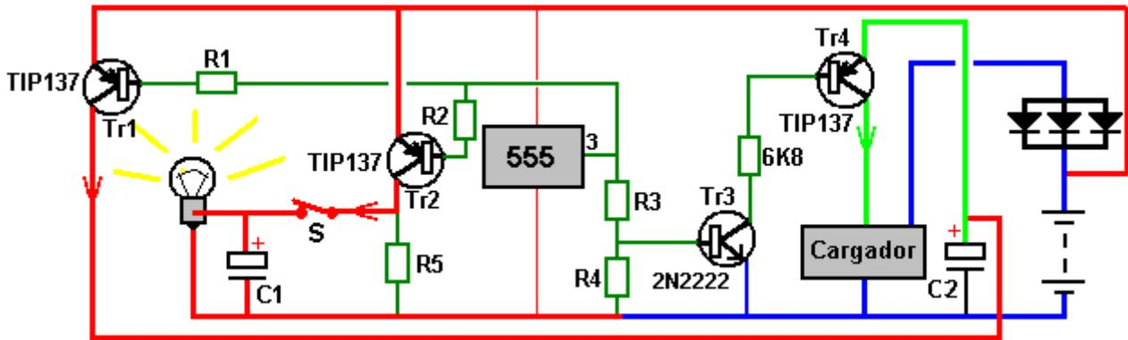
Cuando el pin 3 de la 555 pasa a nivel bajo, las resistencias R1 y R2 de control del flujo de corriente de los transistores TR1 y TR2 conmutación plenamente en el fin de cargar los condensadores C1 y C2. La resistencia R5 es un alto valor de, por ejemplo, 470K y está allí sólo para proporcionar una ruta de flujo de corriente cuando el interruptor S se abre para encender la luz apagada.
