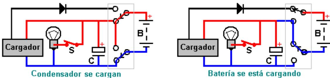
Aquí, el tamaño del condensador "C" se incrementa ya que ahora se suministra tanto a la luz y el circuito de carga, que funciona todo el tiempo. Como los picos de voltaje son de alta tensión y la carga resultante implementaciones actuales muy altas, de estado sólido de esta disposición requieren pruebas de prototipo antes de ser mostrado aquí.
