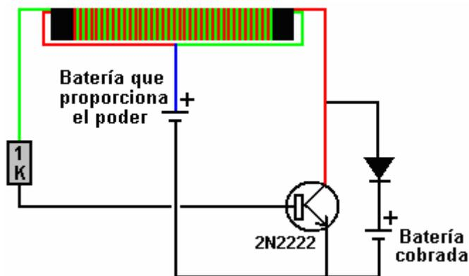
Sin embargo, el circuito tiene una debilidad menor en que si la batería de accionamiento tiene un voltaje mayor que el voltaje de la batería de carga más la caída de voltaje en el diodo, la batería conducirá la corriente directamente a la batería de carga a través del devanado verde que se muestra arriba. a través del diodo. Eso se puede superar poniendo las baterías en serie como lo hizo John Bedini:
