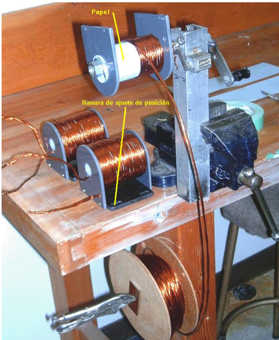
Se ataron los tres bobinas producidos de esta manera entonces a la superficie principal del dispositivo. Allí podido así como fácilmente ha sido seis bobinas. El posicionamiento es hecho para crear un hueco
