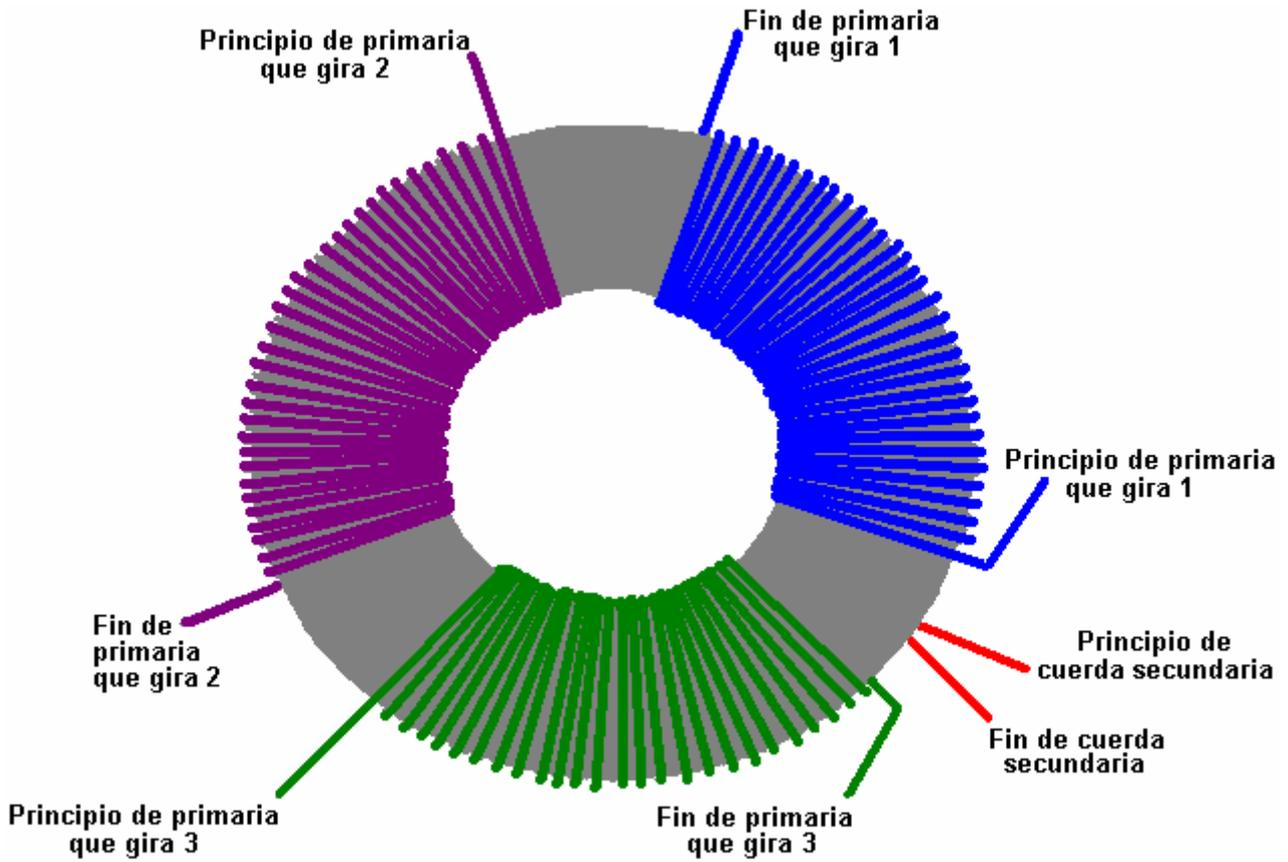
Una vez más, es esencial que el alambre utilizado es sólido, de un solo núcleo de cobre con recubrimiento de plata y el recubrimiento de teflón. El toroide completado está ligada con cinta y se tamiza al ser colocado dentro de una caja de metal con toma de tierra. Las señales de accionamiento para el toroide son así:
