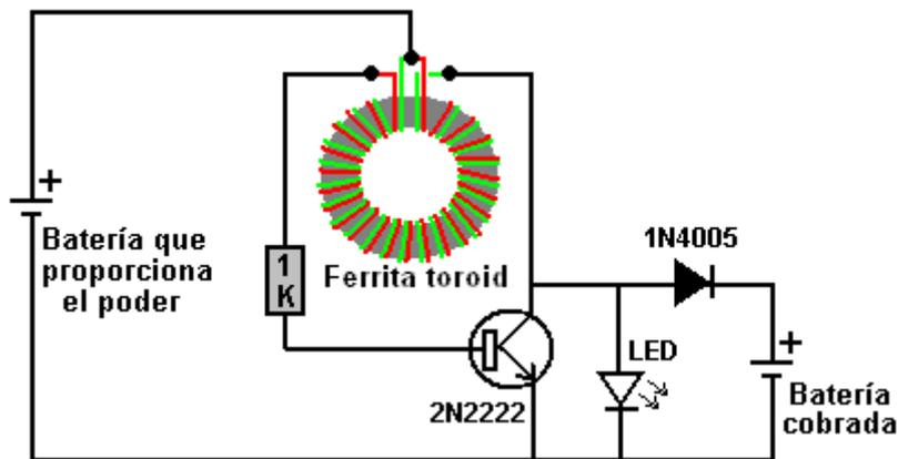
He usado este tipo de circuito sin el LED, para cargar una batería recargable de 0.6 voltios a 1.34 voltios en solo una hora, por lo que es ciertamente efectivo como cargador de batería. El circuito es así:
