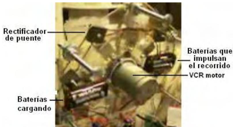
Con este montaje un par de baterías AA arrastran el motor, lo hacen girar moviendo sus imanes en el círculo de las bobinas recicladas produciendo corriente continua rectificada gracias al puente rectificador siendo esta corriente suficiente para mantener girando el motor continuamente.
