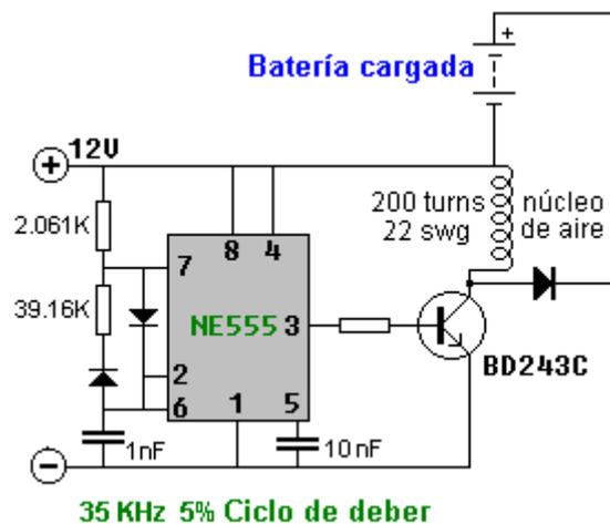
La bobina compacta consta de 200 vueltas de cobre d esmaltado e 0,7 mm.
