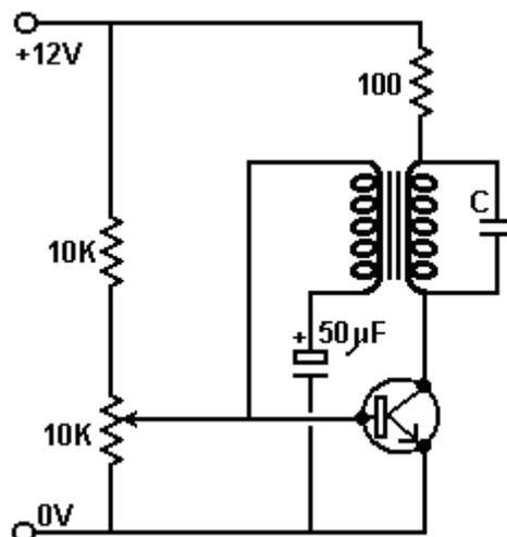
Este es un circuito poco inusual que es compacto y eficiente. La resistencia de 10K fija deja caer el voltaje a través del resistor variable 10 K a alrededor de 6 V para hacer la afinación más fácil. La
