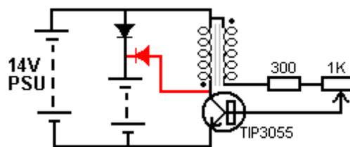
Esa disposición proporciona la red de carga como antes y tensión constante suministro al circuito Ladrón Joule que añade impulsos de carga a la red eléctrica de alimentación de CC a la batería está cargando.
