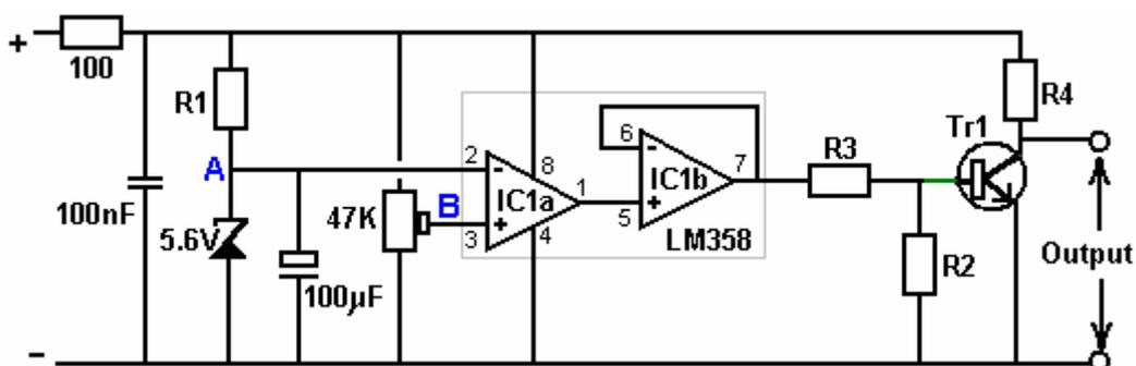
Como este es el circuito para cambiar al aumentar la tensión de la batería, el punto B debe comenzar a una tensión más baja que el punto A. Si está conectado como se muestra, a continuación, Tr1 se enciende cuando la batería se está cargando y se apaga cuando la batería está completamente cargada en un conjunto de tensión por la posición de la corredera de VR1.
