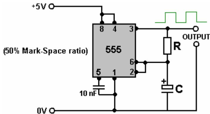
El condensador utilizado debe ser de alta calidad con una fuga muy baja para obtener esta forma de onda que está encendida exactamente el mismo tiempo que está apagada. Esto es importante si queremos que los dos paquetes de baterías reciban la misma cantidad de tiempo alimentando la carga que el tiempo que reciben al recargarse.
