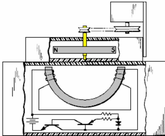
Aquí, cuando el imán de rotor pasa el electroimán curvo en la base, esto enciende los dos transistores que producen un pulso que guarda el hilado de rotor y la bocacalle de generador diminuta. El Andrews produjo este para la división cuando el rotor parece girar en es propio sin cualquier poder de paseo.
