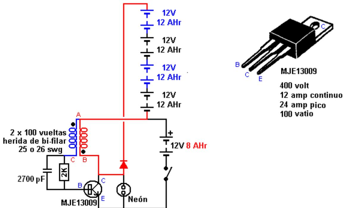
El bobina es la herida en un hueco antiguo, usando dos hilos separados del alambre del diámetro de 0.5 mm, dando a una resistencia de sólo 2 ohmios. Los hilos de alambre son colocados lado al lado en una capa sola como este:
