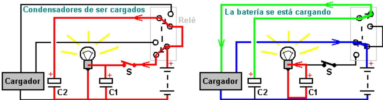
Esto hace que la batería dibujar incluso peor ya que ahora hay dos condensadores grandes que tienen que ser recargado cada segundo mientras que la lámpara es alimentada y el NE555 circuito también está alimentado. Pero, la mitad del tiempo, el relé está en la otra posición que conecta el condensador "C2" pulso-cargador de baterías, y al mismo tiempo, la batería de 'descanso' está conectada a la salida del cargador de pilas, alimentación con cargo a él.
