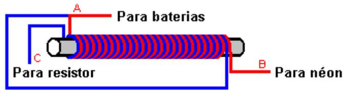
Um possível layout físico usando uma pequena tira de conector elétrico padrão pode ser:
