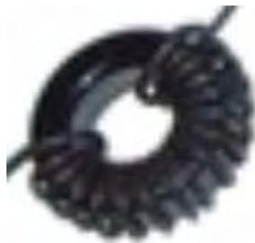
O estrangulamento mostrado em vermelho no diagrama é de cerca de 18 volts em um toróide pequeno que parece bem, mas as duas outras bobinas parecem ser apenas seis ou sete voltas nos cabos de conexão, não enroladas lado a lado em um expo magnético, mas apenas deixado como se encurtasse o comprimento do cabo.
