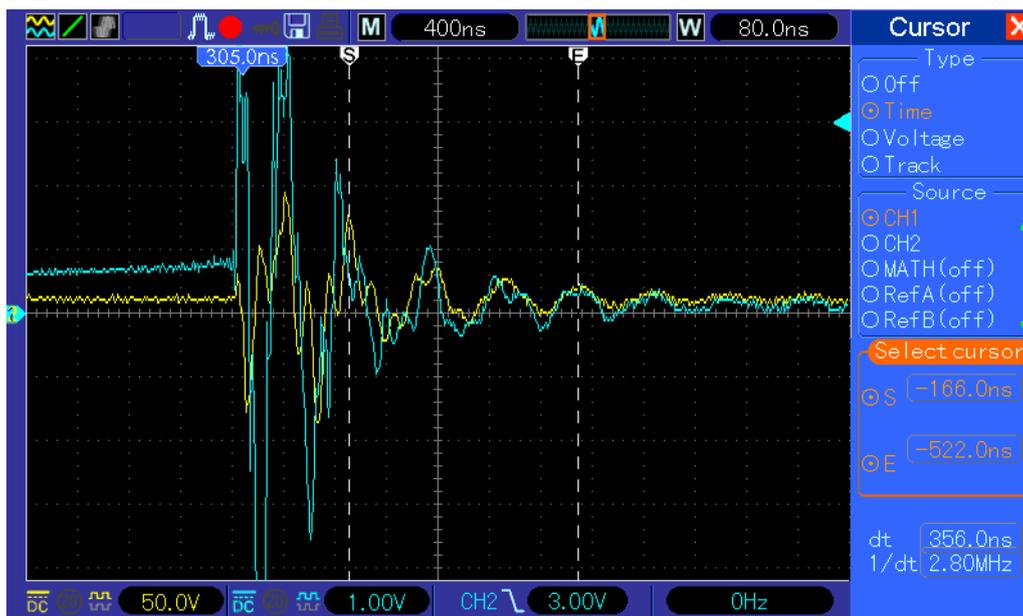
La línea amarilla indica la retroalimentación a la batería. El prototipo utiliza una fuente de alimentación de PVM12 <http://www.amazing1.com/> que está destinado a conducir un globo plasma.
