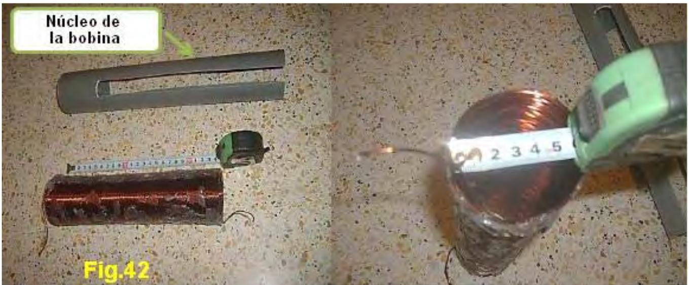
La longitud de la bobina es de aproximadamente 25 cm como se muestra en la Fig.42, el diámetro es de 6 cm, y el grosor del alambre es 1,18 mm (AWG # 17 o swg 18) y el número de vueltas es de aproximadamente 200 Fig.43 muestra algunos agradable chispas de bobina L2:
