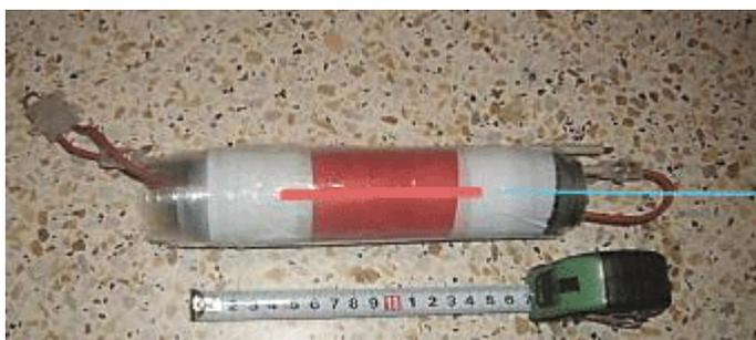
La anchura de la lámina de aluminio es de 10 cm y la longitud de cada placa de condensador es de 120 cm.
