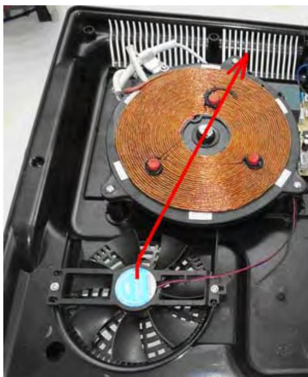
A bobina marrom fica quente, e por isso há espaçadores nela para evitar que a forma externa de revestimento pegue o calor da bobina. Há também um ventilador que puxa o ar de dentro do gabinete e sopra através da bobina para manter o calor baixo.
