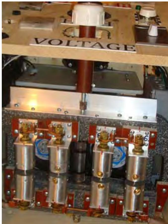
Un detalle a mencionar es la punta de cada chispa. Como esa parte se calienta, usar tungsteno es sensible y por lo que el constructor compró en ocho piezas de cada pulgada (25 mm) de largo y un cuarto de pulgada (6 mm) de diámetro. Estos fueron comprados en eBay:
