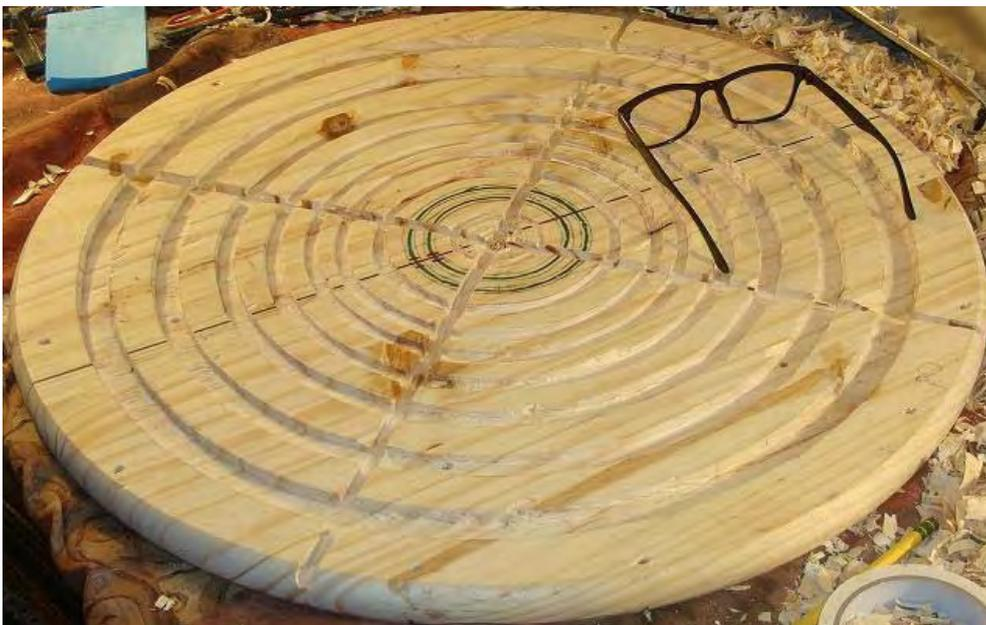
Primero, las posiciones exactas del anillo se señalan en el tablero. Estos son el diámetro de la línea central de cada tubo, el ancho de la ranura y la profundidad de la ranura:
