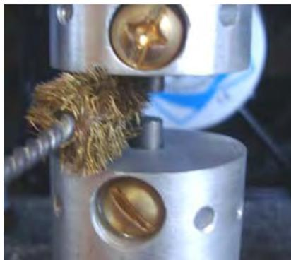
alrededor de las varillas de tungsteno y el aluminio que sostiene las varillas. Cuando esto se ha completado, uso un pequeño archivo y suavemente el final de las dos barras hasta que brillan de nuevo. Entonces los soplo apagado con un limpiador del aire puede para la limpieza del teclado, a menos que el aire comprimido esté disponible, y finalmente, ajuste las separaciones de la chispa al tamaño deseado del hueco.
