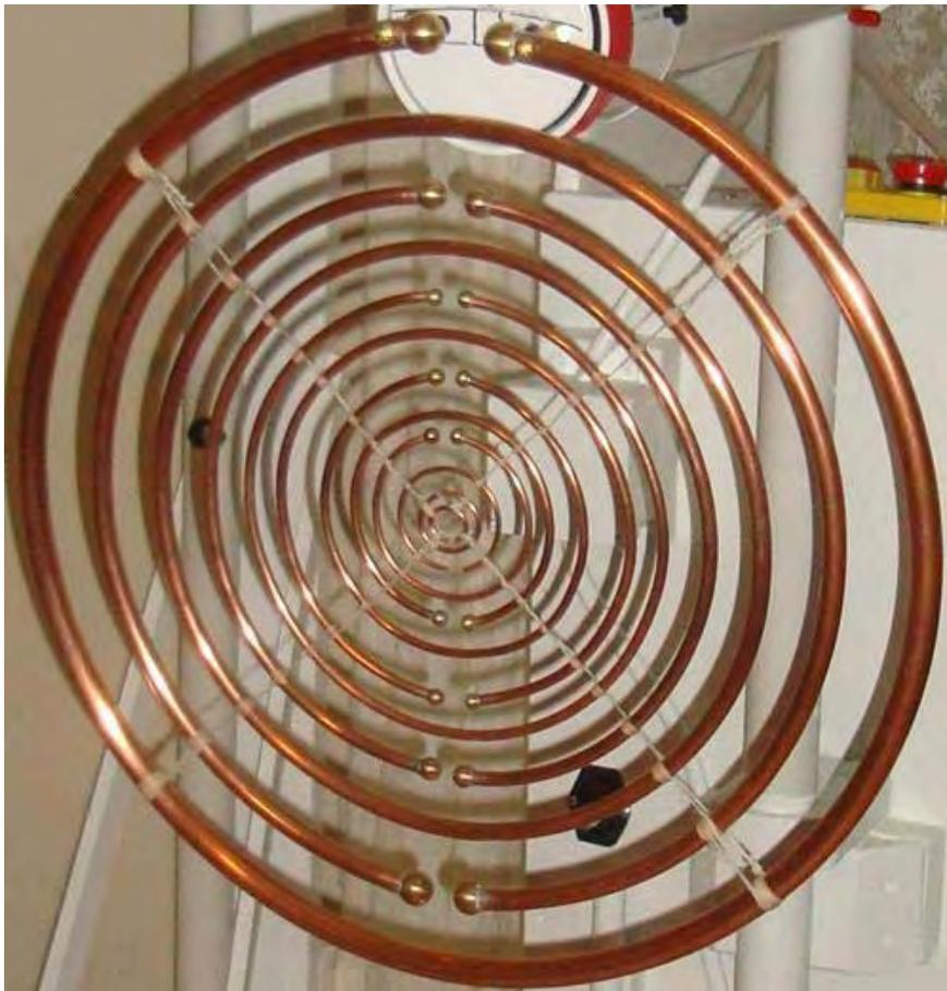
Usted notará que hay muchos diámetros diferentes de tubería de cobre usados en esta antena y que, combinado con el diámetro del círculo en el cual cada tubería está doblada, hace que cada sección de tubo resuene con una frecuencia diferente, y que es el funcionamiento Corazón del diseño, pero más de esto más adelante.
