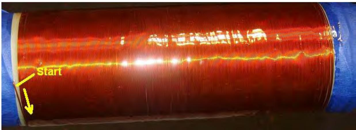
Jedoch müssen die Sende-Tesla-Spule und die Empfangs-Tesla-Spule mit unterschiedlichen Frequenzen in Resonanz kommen, so daß die Empfangsspule mit 350 Windungen der Windung gewickelt wird, um ihm eine niedrigere Resonanzfrequenz zu verleihen. Wir wollen, dass die Frequenzdifferenz zwischen den beiden Spulen 100 kHz beträgt. Das zu erreichen ist nicht so einfach.
