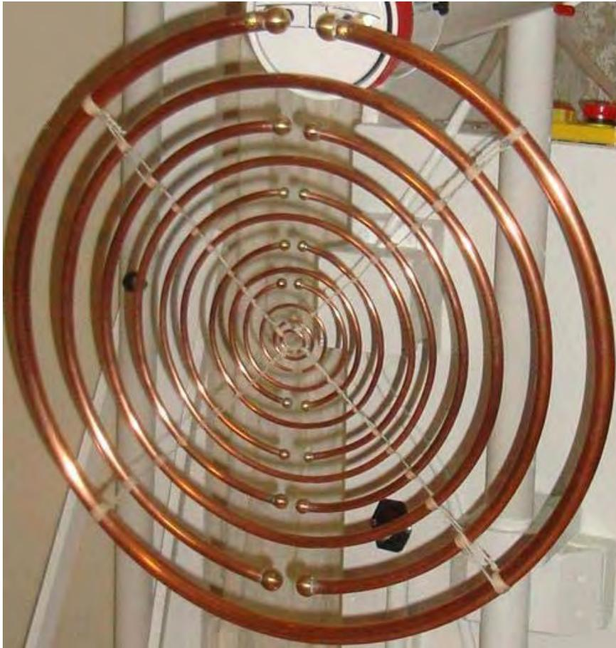
Sie werden feststellen, dass es viele verschiedene Durchmesser von Kupferrohr in dieser Antenne verwendet, und dass in Verbindung mit dem Durchmesser des Kreises, in die jedes Rohr gebogen wird, bewirkt, dass jeder Abschnitt des Rohrs in Resonanz mit einer anderen Frequenz, und das ist der Betrieb Herz des Designs, aber mehr davon später.
