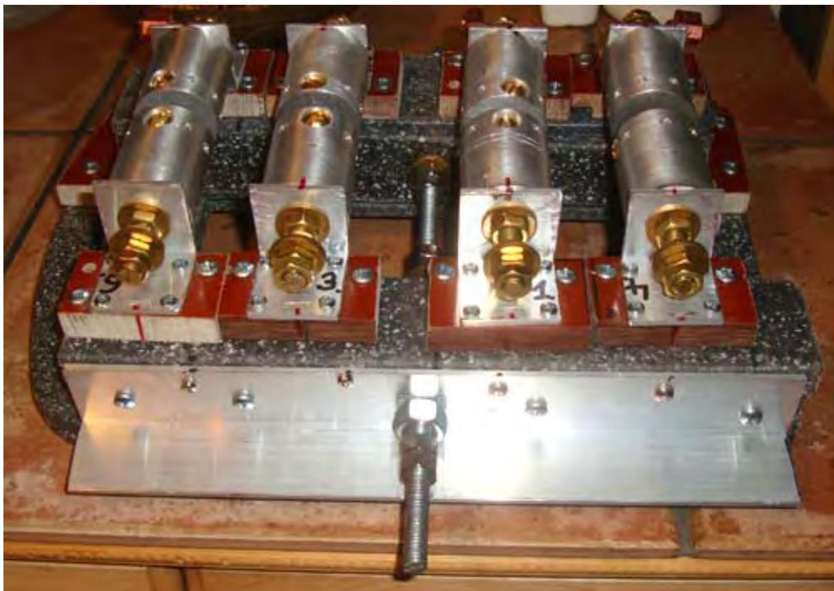
Das Stück Aluminium-Winkel hat die Verstellstange durch sie geleitet, so muss es so gebohrt werden:
