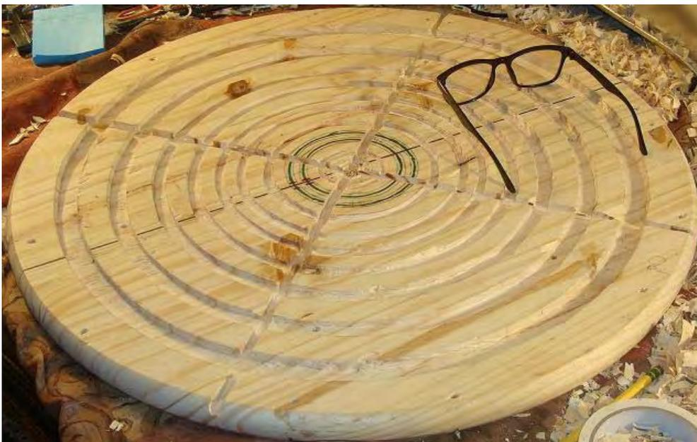
Zuerst werden die exakten Ringpositionen auf der Platine markiert. Dies sind der Durchmesser der Mittellinie jedes Rohres, die Rillenbreite und die Rillentiefe:
