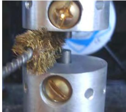
um die Wolframstangen und das Aluminium, das die Stangen hält. Wenn das fertig ist, benutze ich eine kleine Akte und lege das Ende der beiden Stäbe sanft ab, bis sie wieder leuchten. Dann blase ich sie mit einem Luftreiniger für die Tastaturreinigung ab, es sei denn, Druckluft ist vorhanden und endlich die Funkenstrecken auf die gewünschte Lückengröße einstellen.
