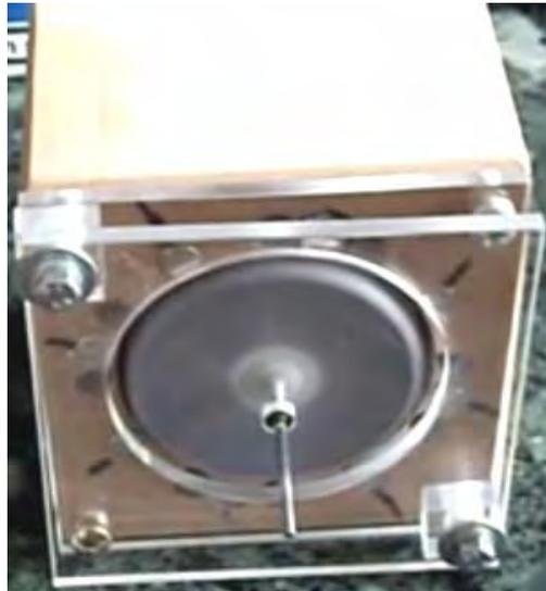
Como não há comentários com o vídeo, é um pouco difícil captar todos os detalhes, mas parece que os ímãs do estator de posicionamento permitem que o motor supere o ponto normal de aderência do arranjo típico do motor em V. O vídeo mostra vários arranjos incluindo o agrupamento não simétrico mostrado aqui onde quatro ou cinco ímãs consecutivos são usados e os slots restantes deixados vazios:
