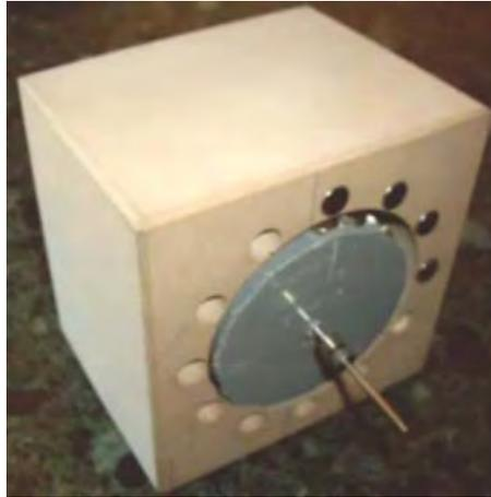
Das Gehäuse verfügt über beträchtliche Spielraum für die Trommel und Magnete. Der hintere Wellenlager wird einfach in die Rückseite des Gehäuses gesetzt:
