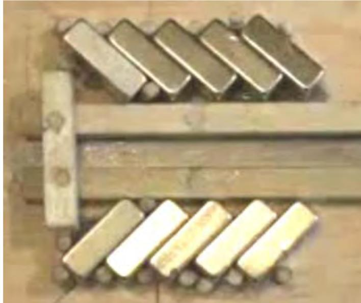
Die Magnete sind an Ort und Stelle in diesem Bild hielt, durch Holzdübel in die Basis Planke getrieben. Sie verwendet diese, um jegliche Magnet-Befestigungsmaterials, die das Magnetfeld verändern könnten, zu vermeiden.
