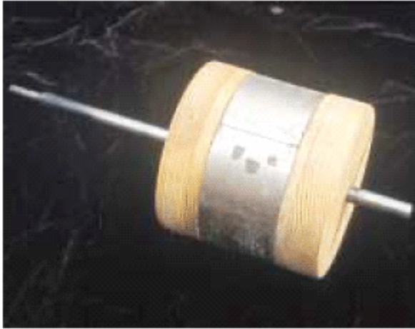
La armadura de madera sostiene ocho imanes neodimio-hierro-boro arreglados con la polaridad alternadora alrededor esto es el perímetro
