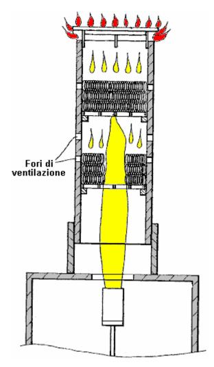
Sig. Kim ritiene che l'esano impedisce di accensione ritorno di fiamma. Egli non sembra specificare il materiale di riscaldamento all'interno del bruciatore ma è probabilmente lana di acciaio inossidabile. Egli parla di pressioni dei gas di 1 Kg per cm<sup>2</sup>., Che, se i miei calcoli sono corretti è 14,22 psi. che non è possibile per il 100% del gas HHO come sarà esplodere spontaneamente a 12 psi. grazie al suo stato di alta energia e carica elettrica.
