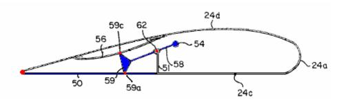
Questo spinge contro la molla **56**, comprimendolo. Il collegamento triangolo **59** si muove verso l'alto, rotazione nei punti **59a e 59c**, e alzando la sezione **50** della banderuola. Questo cambia la forma della paletta, come mostrato qui:
