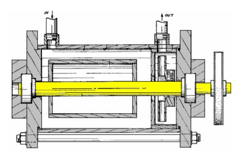
Questo richiede una precisione molto maggiore di costruzione in cui il liquido deve essere contenuta anche se ha un albero rotante che attraversa l'alloggiamento. Questo dispositivo pompa il liquido riscaldato con riscaldamento centrale tubazioni e termosifoni.
