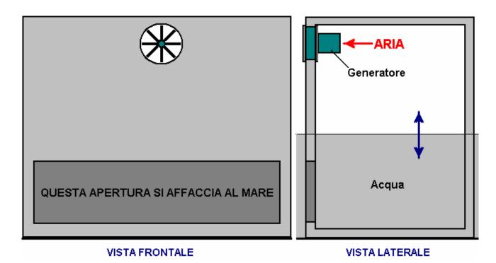
Qui, una grande apertura consente il mare a fluire nella struttura che rende il livello dell'acqua all'interno della scatola muoversi su e giù con il moto ondoso esterno. Come un'onda passa, comprime l'aria all'interno della scatola e l'aria viene espulso attraverso l'apertura generatore, girare le pale del generatore stesso modo di un generatore eolico ha le sue lame filata dal vento.
