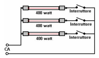
Ho cambiato le connessioni all'interno del mio riscaldatore particolare, in modo che tutte e tre le lampade alogene sono collegati in una catena. Questo non ha portato tagliare i fili o effettuare nuove connessioni a tutti i cavi di collegamento alle lampade hanno connettori a pressione 'a forcella' sia per consentire di produzione semplice e facile sostituzione di una lampada alogena. Il nuovo accordo è così:
