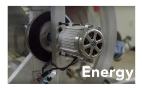
Questo è il generatore che è filato da cinghia di trasmissione dai pedali. La ruota con il cerchio grande costituisce un volano e anche se lui non ne parla, il volano provoca un guadagno di energia. La base per la compilazione è simile al seguente:
