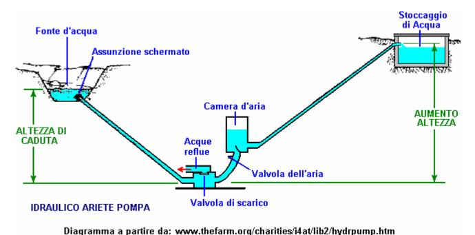
Le prestazioni di una pompa di Ram è impressionante, anche se ha solo due parti in movimento. Con una caduta di ingresso di soli quattro metri e una portata bassa di soli tre litri al minuto, una pompa Ram può fornire 69 litri al giorno per una altezza di 100 metri massiccia verticalmente sopra la pompa. O, 159 lpd a 60 metri sopra la pompa, o 258 lpd per un'altezza di 40 metri sopra la pompa. Questo è impressionante per un dispositivo semplice.
