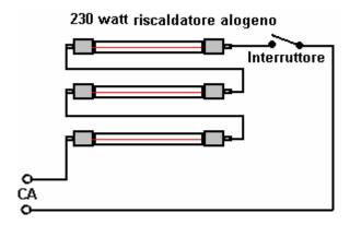
Questa disposizione 'sotto-dimensiona' le lampade perché ogni lampada ha solo un terzo della tensione per cui è stato progettato. Questo ha l'effetto di aumentare la durata della lampada enormemente. Ci si aspetta l'uscita di calore per essere molto povera, e forse lo è. Ma dà l'impressione di essere molto efficace e con tutte le tre sezioni di lavoro, fornisce un calore delicato e leggero che sembra molto efficaci nel mantenere un ambiente caldo.
