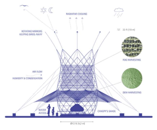
Fornito in kit di montaggio, utilizzando elementi strutturali di bambù, questa unità è di 4 metri di larghezza e 9 metri di altezza con rotazione specchi per spaventare gli uccelli. Con la raccolta di acqua passiva da nebbia, pioggia e rugiada, testato in Etiopia può produrre tra 50 e 100 litri al giorno. Il materiale di condensazione è la rete di plastica.
