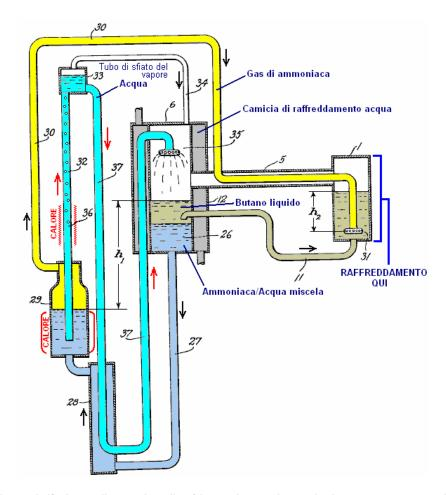
La nostra invenzione si riferisce alla tecnica di refrigerazione e in particolare a un apparecchio e metodo per la produzione di refrigerazione in cui il refrigerante evapora in presenza di un gas inerte e più in particolare, del tipo descritto nel Von Platen e Munters Patent No. 1.685.764 del 25 settembre 1928 e il nostro brevetto inglese n° 282428.
