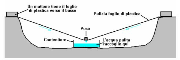
L'area sotto la lamina di plastica viene riscaldata dall'effetto serra. L'umidità arriva anche dalla terra all'interno del foro chiuso. L'umidità dell'aria nella cavità condensa sul lato inferiore del foglio di plastica. Ma come il foglio di plastica è modellato in una piramide rovesciata a causa del peso proprio sopra il contenitore, l'acqua scorre e gocciola nel contenitore. Anche in questo caso, nessuna energia d'ingresso richiesto e senza parti in movimento.
