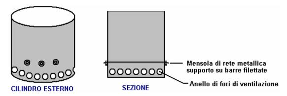
Un anello di fori di ventilazione è forato intorno tutto il bordo inferiore delle aste filettate e barile sono eseguiti attraverso il barile. Questi supportano un cerchio di rete metallica che forma una mensola di supporto.
