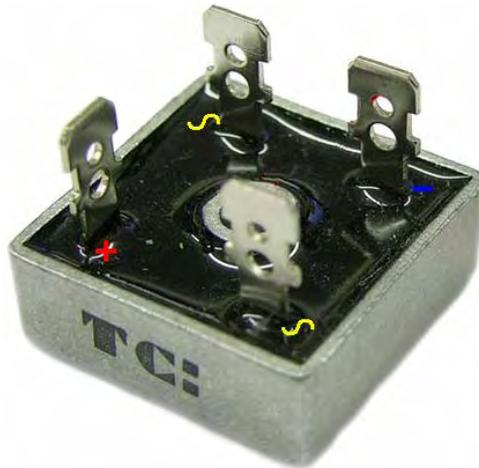
La señal alterna está conectado entre dos esquinas opuestas y la DC pulsante está despegado de los otros dos terminales. Los símbolos indicados arriba son normalmente marcadas en la cara plana que no se ve en esta imagen. El paquete tiene un agujero en el centro, de manera que la carcasa de metal puede ser atornillado a un disipador de calor con el fin de mantener el dispositivo razonablemente frío al llevar a grandes corrientes. Las conexiones en el interior del paquete son así:
