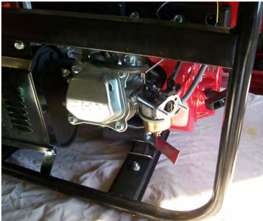
Dies ermöglicht den Zugang zu dem Vergaser, der dann entfernt wird, wenn es nicht verwendet wird:
