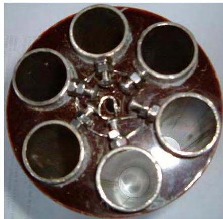
Die elektrischen Verbindungen zu den Rohren sind über Edelstahl draht läuft zwischen Edelstahlbolzen in die Rohre abgegriffen und Edelstahlbolzen Durchlaufen der Unterseite des Geräts:
