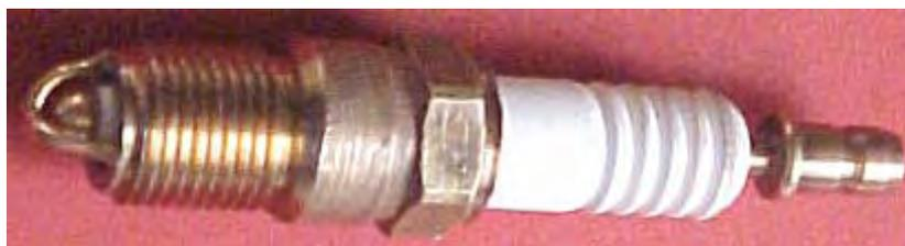
Allerdings ist dieses Plug weit von gewöhnlichen. Die zentrale Elektrode wurde aus einem zylindrischen Pfosten worden zu einer halbkugelförmigen Kuppel verändert, umgeben von vier gewölbten Elektroden, von denen jede in einem konstanten Abstand von der Halbkugel angeordnet ist. Dies ermöglicht eine sehr viel größere Fläche und Funken führt zu sehr viel bessere Leistung.
