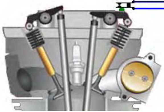
Eine Alternative besteht darin, eine starke Dauermagneten zum Kipphebel befestigen, mit Epoxidharz, und positionieren eines Festkörper "Hall-Effekt"-Sensor, so daß sie die Verzögerung auslöst, bevor der Funke erzeugt wird.
