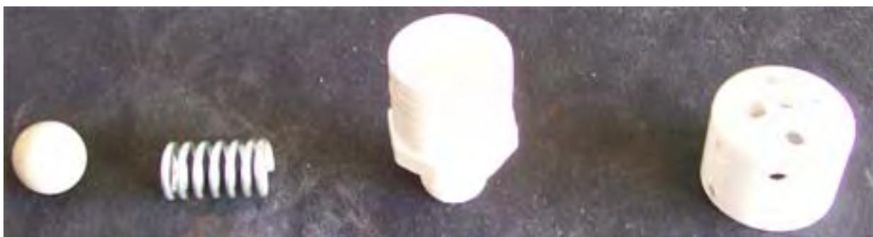
Diese Komponenten werden dann zusammengebaut, um das Überdruckventil zu erzeugen:
