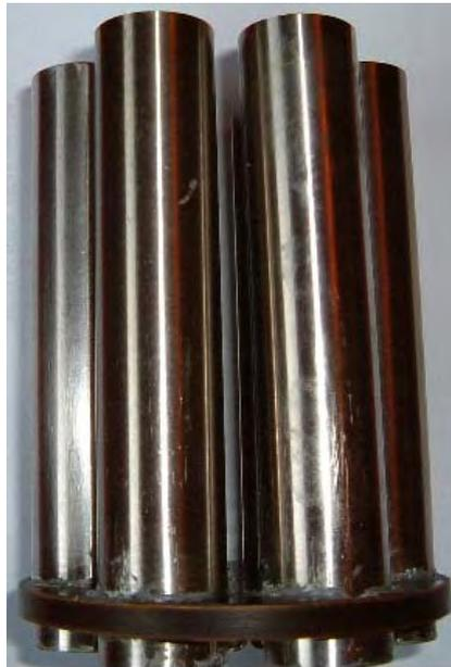
Hier ist die Anordnung bereit, die Innenrohre (verkeilt einrastet durch kleine Stücke aus Gummi) zu empfangen:
