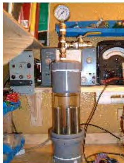
Die Elektrolyse findet zwischen jeder der inneren und äußeren Röhren. Das Bild oben zeigt die Blasen gerade erst anfangen, um die Rohre zu verlassen, nachdem der Strom eingeschaltet ist. Das Bild unten zeigt die Situation ein paar Sekunden später, wenn der gesamte Bereich oberhalb der Rohre so voll von Blasen ist, dass es völlig undurchsichtig:
