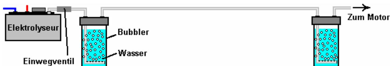
Dabei ist der erste Sprudler ist in der Nähe des Verstärkers und die zweite in der Nähe des Motors angeordnet. Einmal in eine Weile, kann das Wasser aus dem ersten Wäscher zur Aufstockung das Wasser im Inneren des Verstärkers, so dass keine Spuren von Hydroxid die Bubbler erreicht haben, um den Booster zurückgegeben werden, erhalten ihre Elektrolytkonzentration genau richtig und dafür zu sorgen, dass das Wasser in der Waschflasche ist immer frisch.
