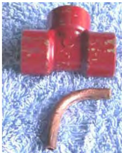
Das Kupferrohr wird dann mit einem Klempner Gasbrenner erhitzt und gebogen sehr langsam und vorsichtig an die Form oben gezeigt. Manche Menschen finden es hilfreich, eine Länge von geeigneten flexiblen Material in das Rohr legen, bevor die Biege - so etwas wie der gewickelten Stahlfeder Material verwendet, um Gardinen unterstützt - wie die an das Kupferrohr von Knicken, wenn gebogen zu halten hilft.
