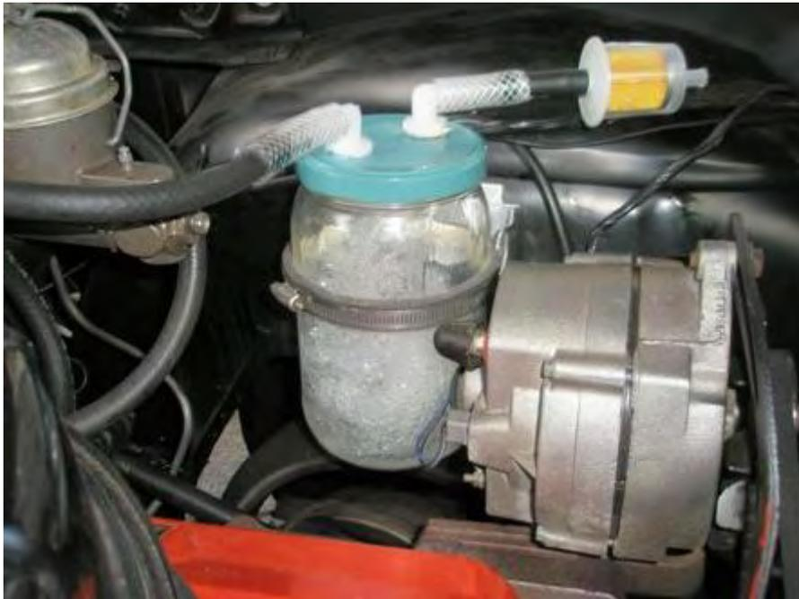
Sie werden bemerken, dass der Kraftstoff im Behälter gehalten wird ziemlich niedrig, damit viel Platz, um die Luftblasen enthalten, so dass sie zu knallen und nicht in die Luftröhre gezogen werden, die Futtermittel den Motor.
