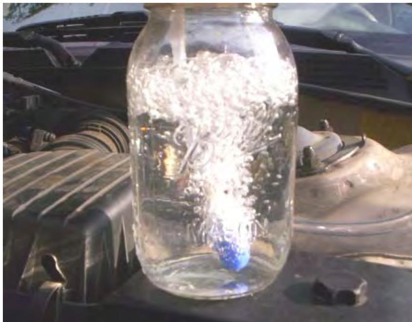
Die Einheit ist mit dem Lufteinlass des Fahrzeugs befestigt, zwischen dem Luftfilter und dem Motor. Eine kleine Durchmesser Kunststoffrohr ist Blei von dort zu einem Glas oder Kunststoff Behälterhalteeinrichtung Wasser. In dem obigen Bild Roger wird mit einem Glas Einmachglas mit einer Schraube-on Metalldeckel, die eine Dichtung hat. Manchmal auch ein Einmachglas, sind diese Gläser sehr bequem.
