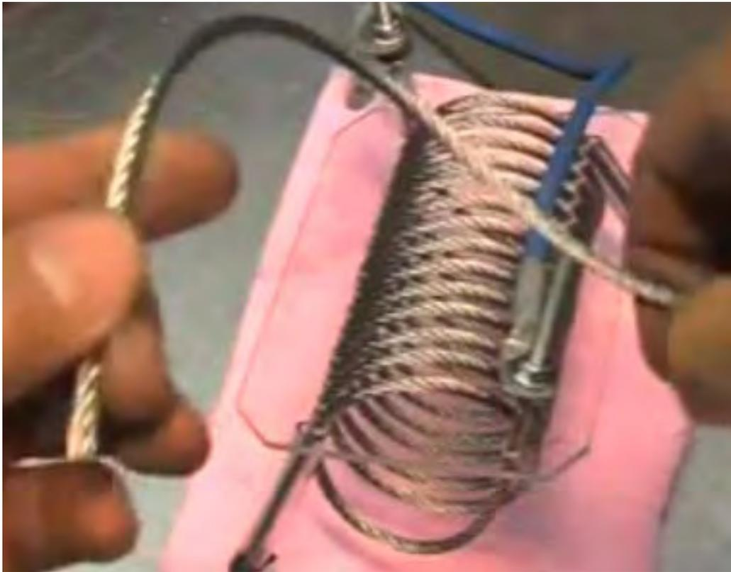
Es ist von Schiffschandleries weltweit und ist aus rostfreien Stahldrähten aufgebaut. Wenn wir diese verwenden, dann müssen wir die Tatsache, dass es elektrischer Widerstand hoch sein zu akzeptieren, aber der große Vorteil ist, dass wir nur die Abstandhalter aus Kunststoff zu machen.
